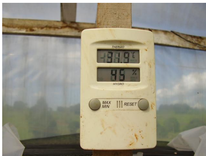
Figura 17 - O controle da temperatura e umidade relativa foi realizada com a utilização de um termohigrômetro. Fonte: Clóvis A. Schwertner.
