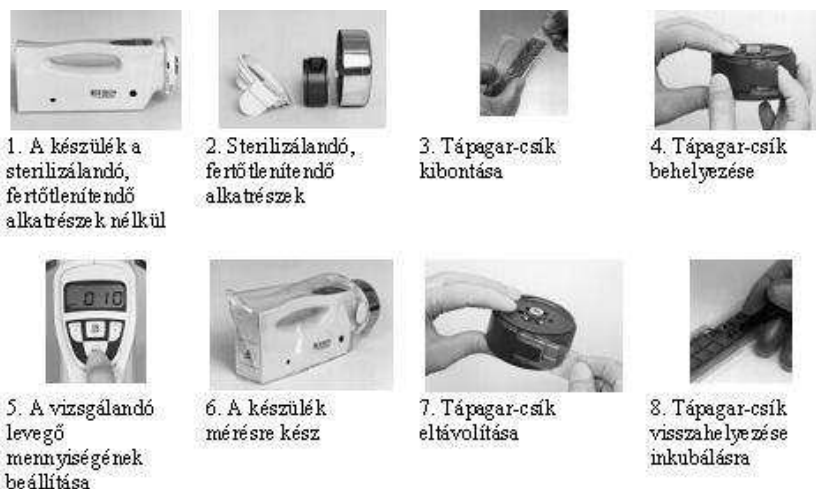
11.5.1. ábra: Az RCS Plus levegőminta-vevő készülék használata képekben
