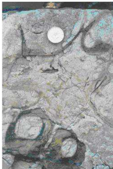
2.4.4. ábra: A kioldott Megalodus-héjak helyét kalcitcement és/vagy finom üledék tölti ki. Felső-triász mészkő. Tata, Kálvária-domb (Lantos Z. felvétele)
