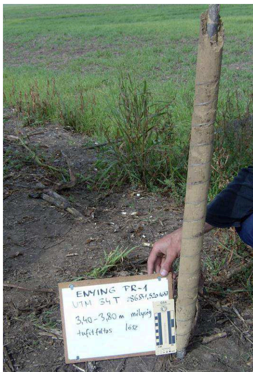
1.15.6. ábra: Sekélyfúrás szegmensének fényképi dokumentálása. A fúrószár mellé helyezett skála (ld. 1.15.5. ábra) és a tábla felirata együttesen adja meg a fúrás nevét, helyét, a szegmens mélységét, fontosabb jellemzését és a kép skáláját
