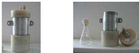
11.4.2. ábra: Mélységi víz-mintavevő
