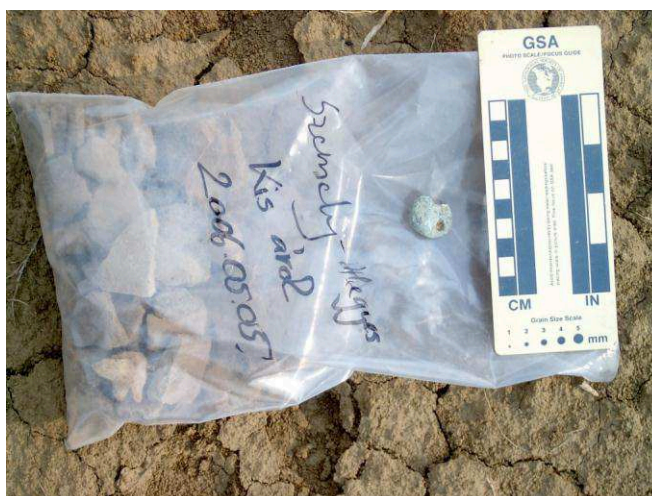
1.12.1. ábra: Terepi mintagyűjtő zacskó feliratozása (helyszín és dátum) és fénykép dokumentációja (a skála ezért van a minta mellé helyezve). A mintazacskó számát vagy azonosító jelzetet is kap, ha több mintazacskónk is lesz a területről
