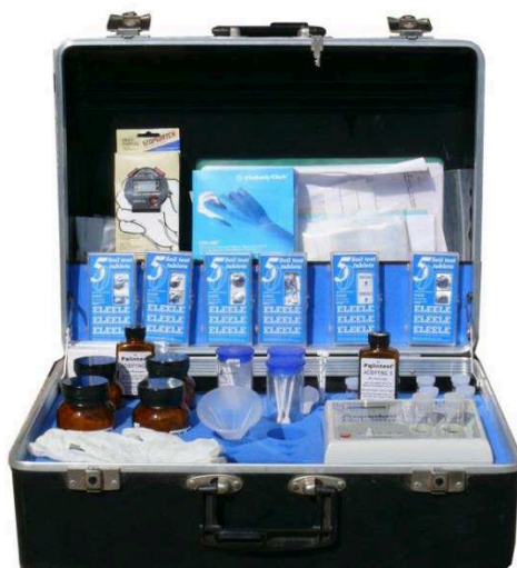
2.2. ábra. Makro- és mikroelemek, valamint a pH vizsgálatára szolgáló talajanalitikai készlet
