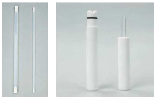
4.10. ábra- „Bailer”-mintavevők (ITENVIRO, Budapest; EAE, Giesbeek, Hollandia)
