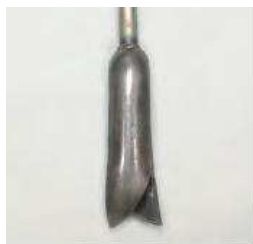
2.10. ábra. Fűrőfej köves talajra (ITENVIRO, Budapest; EAE, Giesbeek, Hollandia)
