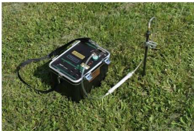
2.25. ábra. Talajradonkoncentráció-mérő berendezés (radondetektor, műanyag cső, páralekötő, talajszonda) (a felvételt készítette Szabó, Á.)
