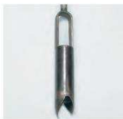
2.11. ábra. Fűrőfej öntéstalajra (riverside fűrőfej) (ITENVIRO, Budapest; EAE, Giesbeek, Hollandia)
