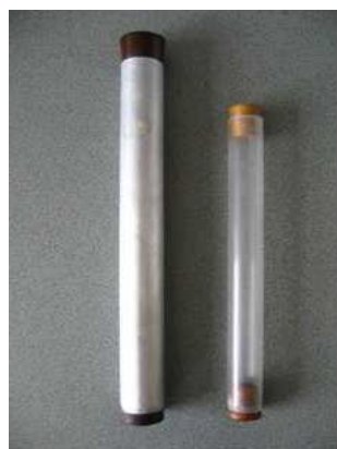
4.3. ábra. Plexi- és fémcső talaj/üledék-mintavevők
