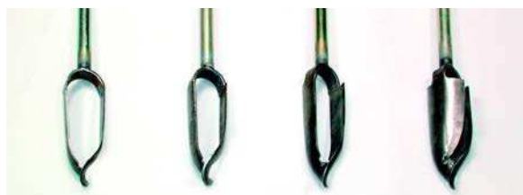
2.9. ábra. Edelman-féle fűró. Agyagos talajokhoz (balra); és homokok mintázásához (jobbra) (ITENVIRO, Budapest; EAE, Giesbeek, Hollandia).
