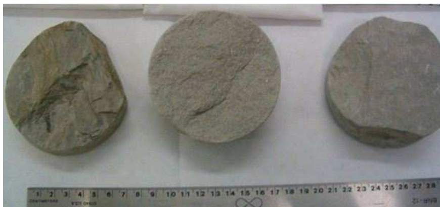
2.27. ábra. Fúrólyukból származó, henger alakú kőzetmagok, amelyekből a mintavételt elvégezhetjük
