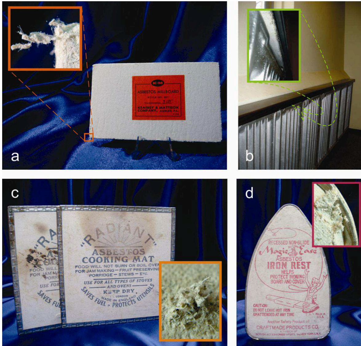
9.1. ábra: Azbesztkarton jellegű, hőszigetelő asbesztalkalmazások. Az asbesztkarton a kartonpapírhoz hasonló módon készül, a rövid, jól foszlatott, szennyeződésmentes asbesztszálak helyettesítik a papírgyártás cellulózrostját. Az asbeszttartalom 60–97%, a töltőanyag kaolin és a ragasztó keményítőszármazék (Frank, 1952). Az asbesztkartont gyártottak krizotilból és kékasbesztből is, utóbbi a savaknak jobban ellenállt. a) Azbesztkarton, hőszigetelőlap, Magyarországon is alkalmazták pl. tűzhely és fa konyhabútor elválasztására. b) Azbesztkarton szigetelés radiátor és fedőburkolata között. c) Fémperemmel ellátott krizotilazbeszt lábosalátét tűzhelyre, funkcióját tekintve az asbeszt-háléhoz hasonlítható. A nagyított részlet a sérült, száleresztő felszínt mutatja. d) Fémperemmel és talppal ellátott vasalóalátét, a vasalódeszkát védi a forró vasalótól. Ennek felszíne is eresztí a szálakat. A képek forrása: © Asbestorama – flickr.com
