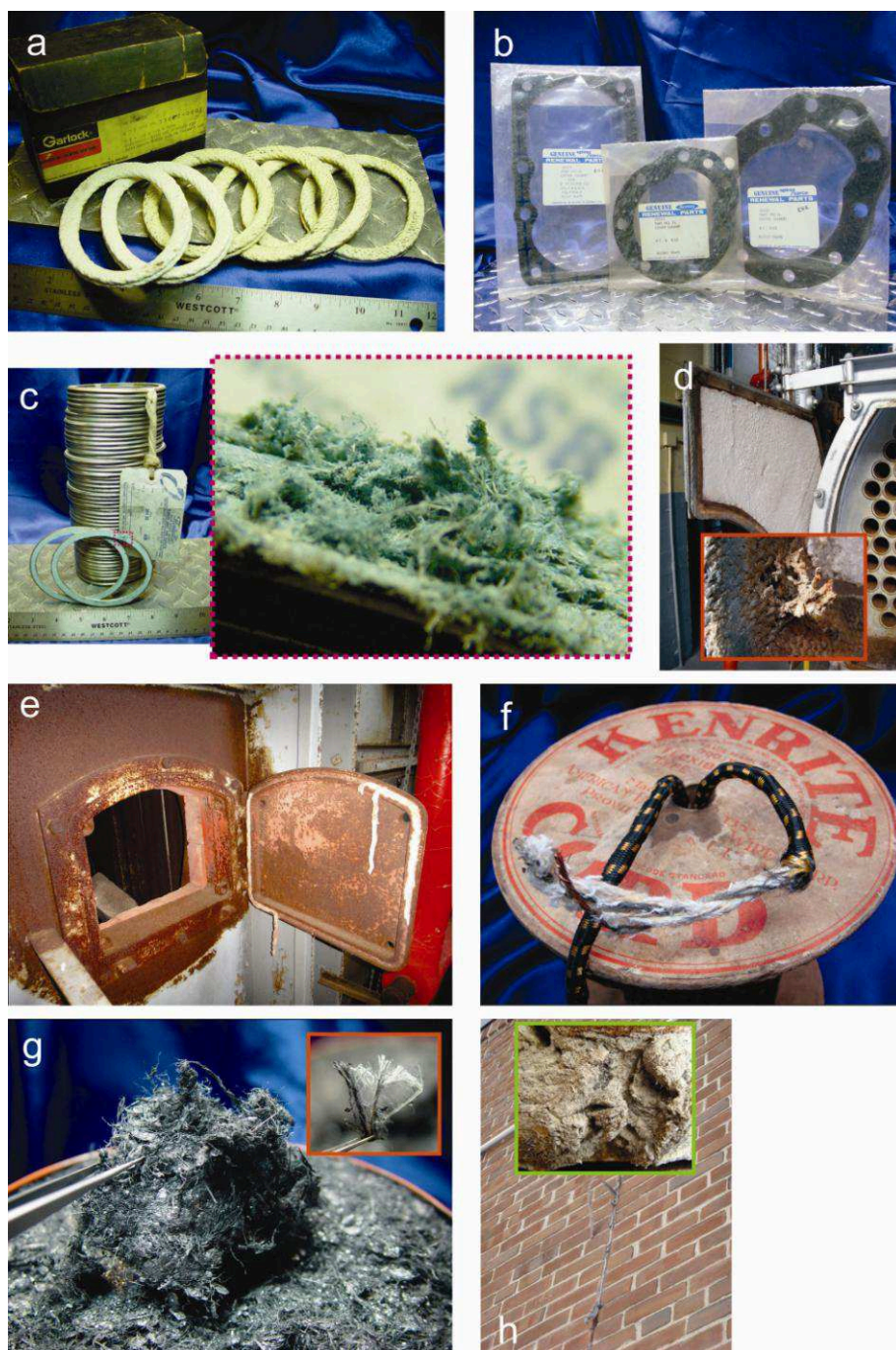
9.3. ábra: Azbesztek gépipari alkalmazásai. a) Azbesztes tömitőgyűrű, dróterősítésű szőtt azbesztből, tipikusan gőzkazánok ellenőrzőnyílásánál alkalmazták. b) Azbesztes tömitőgyűrűk. c) Kékazbeszt (riebeckitazbeszt) tömitőgyűrű fém foglalattal. d) Kazánajtó, belső oldalán fehér azbesztbélés, a peremén rozsdásodó szőtt azbeszt tömitőszalag fut körbe (kinagyítva). e) Kazánajtó szakadt fehér azbesztzsinór tömitéssel. f) Elektromos vezeték (sodort rézhuzalköteg) fehér azbeszt szigeteléssel és fekete-sárga szőtt textil burkolattal. g) „Karbonit” (Carbonite) márkájú tömités, hosszú szálú krizotilazbeszt és grafit laza keveréke, csőelzáró szelepek házába való. A grafit síkosít, biztosítja a szelep könnyű elforgatását, és megfelelően elszigeteli a szelepet a nagynyomású folyadékoktól, gázoktól. h) Krizotilazbeszt tömitőzsinór épület dilatációs (tágulási) részében, a mállott zsinór rideg, porlódik. A b) és f) alkalmazások kivételével kiporzás elleni (felületi) védelmet nem tartalmazó azbesztalkalmazások. A képek forrása: © Asbestorama – flickr.com
