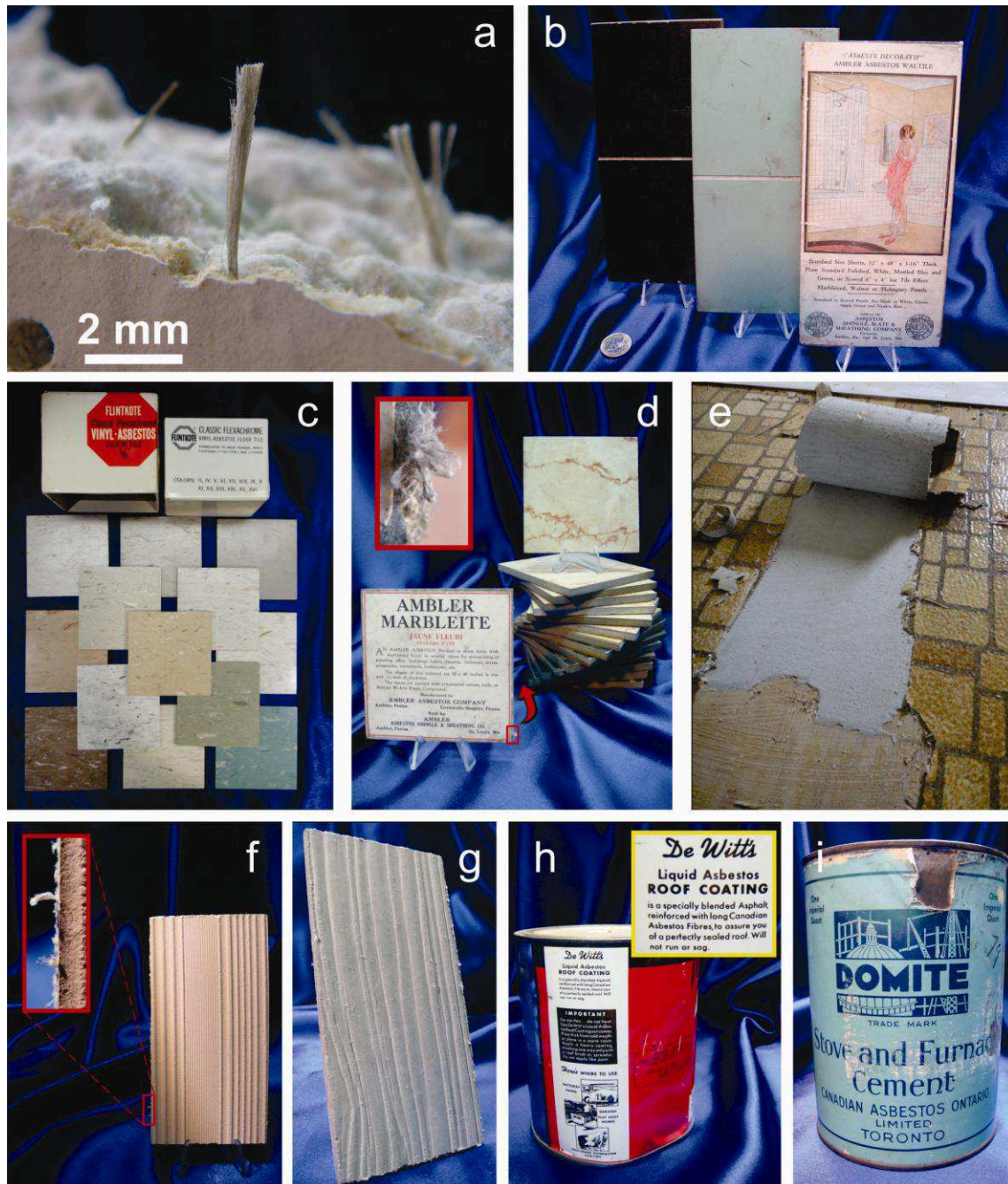
9.6. ábra: Nagy kötőanyag-tartalmú, azbesztes kompozit építőanyagok. a) Gruneritazbeszt (amozit vagy barnaazbeszt) szálkötegeket tartalmazó álmennyezeti panel. Az azbesztest ásványgyapotba ágyazták, a panelt rózsaszín festékburkolat borítja. b) Zománcborítású azbesztcement lap, csempeutánszat. c) Azbeszttartalmú műanyag padlólapok 1962-ből. d) Márványhatású beltéri azbesztcement burkolólapok. e) Linóleumpadló, sötét színű azbesztpapír hátlappal. A műanyagpadló szakszerűtlen cseréjekor az azbesztpapír porlódhat, szennyezheti a környezetet. Előfordulhat az is, hogy nem maga a műanyagpadló, hanem a ragasztóanyag tartalmaz azbesztest, nyilván tűzvédelmi célból. f) Azbesztcement zsindegy, a peremén kitüremkedő krizotilazbeszt szálkötegekkel. g) Texturált felületű (famintázatot utánozó) azbesztcement falburkoló lap. Az azbesztszálkötegek jól láthatóan a lap felszínén is kiállnak az alapanyagból. h) Kenhető aszfalt tetőszigetelés, „hosszú szálú kanadai azbeszttel” (=feltehetően krizotil). i) Kazán- és kályhaépítéshez való azbeszttartalmú cement. A képek forrása: © Asbestorama – flickr.com
