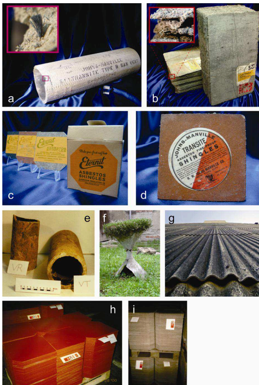
9.7. ábra: Azbesztcement termékek. a) Krizotil- és riebeckitazbesztet egyaránt tartalmazó azbesztcement cső, a nagyítás a tört felszínből kiálló riebeckitazbeszt szálköteget mutatja. b) Durva kidolgozású, kőzetből hasított tetőfedő palára emlékeztető azbesztcement tetőfedő pala, a durva kidolgozás miatt a peremeken a szokásosnál könnyebben szabadulhatnak ki az azbesztszálak a cement kötőanyagból. c) Azbesztcement síkpala, eternit márkanéven, utalva a termék tartóságára (a latin aeternus szó jelentése tartós, végtelen, örökkévaló). d) Azbesztcement pala, a címke tanúsága szerint tűzálló, „gyakorlatilag elpusztíthatatlan”. Nem a megszokott módon, elemi szálcement rétegek egymásra rakásával készült, hanem egyben, az azbesztcement formába préselésével. e) Budapesten évtizedeket szolgált ivóvíz nyomócsövek. f) Azbesztcement virágédény. g) Azbesztcement hullámpalával borított épület a felhagyott krizotilazbeszt bányában (King mine, Thetford Mines, Kanada). h-i) Krizotilazbesztet tartalmazó festetlen (h) és festett (i) síkpala raklapon, az azbesztre figyelmeztető jelzéssel a nyergesújfalui eternitgyárban, 2000-ben. A képek forrása: a-d) és g): © Asbestorama – flickr.com; e-f), h-i): Tóth Erzsébet
