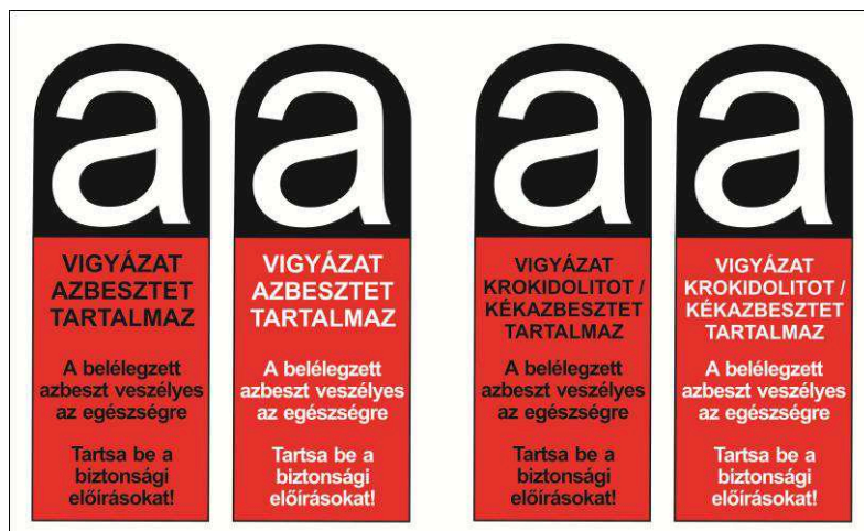
3.4.4. ábra. Az azbesztek jelenlétére figyelmeztető jelzés a 44/2000. (XII. 27.) EüM rendelet szerint. A rendelet azt is kiköti, hogy a legveszélyesebb azbesztet (riebeckitazbeszt) tartalmazó anyagnál az „azbesztet tartalmaz” feliratot „krokidolitot/kék azbesztet tartalmaz” felírra kell módosítani. A jelzés minimális mérete 5 cm × 2,5 cm (A jelzés alakja, színezése és szövege megfelel az 1907/2006/EK (2006. 12. 18.) rendeletben foglaltaknak is. 11)
