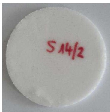
8. ábra: Béta-ciklodextrin gyöngypolimert tartalmazó, szintereléssel előállított nanoszűrő
