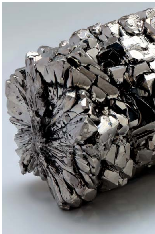
Tyč extrémně čistého (99,995%) krystalického titanu vyrobeného van Arkelovou-de Boerovou metodou; průměr 2,5 cm. Zdroj: Wikipedia
