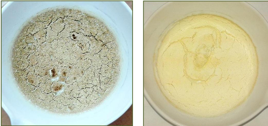
**Figura 4.12.** Fracciones ricas en celulosa (izquierda) y holocelulosa (derecha) siguiendo Rutas 1 y 2, respectivamente
