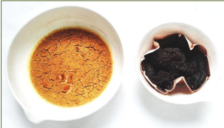
**Figura 4.4.** Fracción rica en hemicelulosa antes (derecha) y después de purificar (izquierda)
