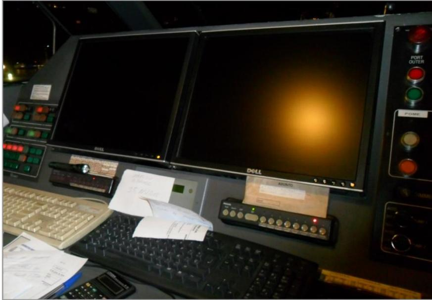
*Ilustración n° 14: Ordenador de alarmas del puente.
