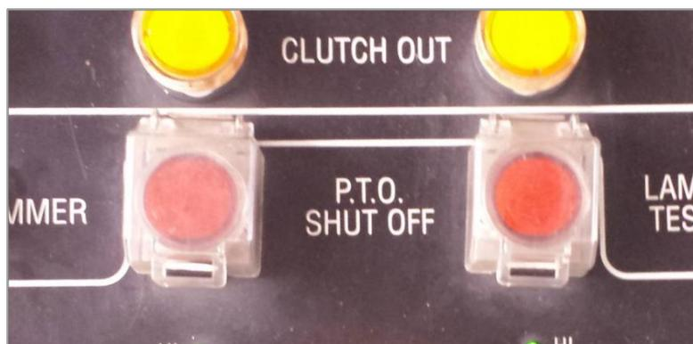
Ilustración nº 51: Botonera de activación de la válvula shut off.
