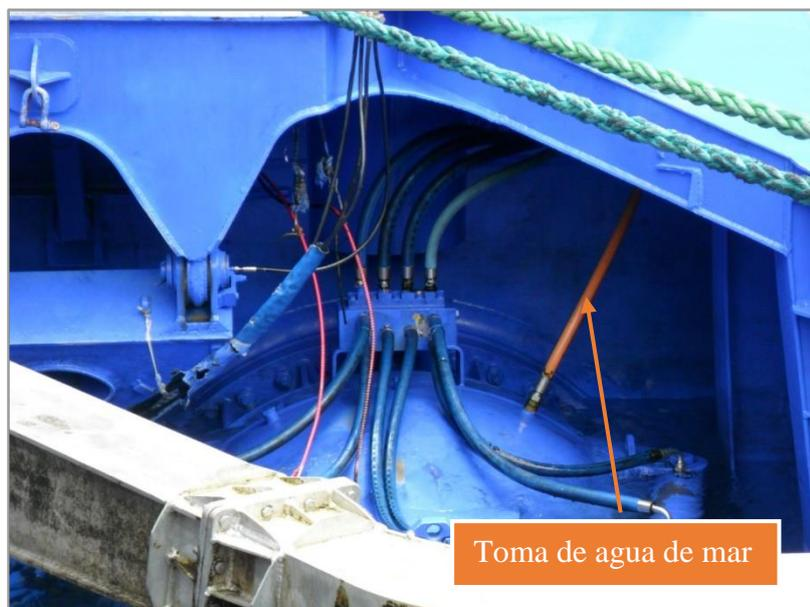
*Ilustración n° 114: Toma de agua de mar para el enfriador.
