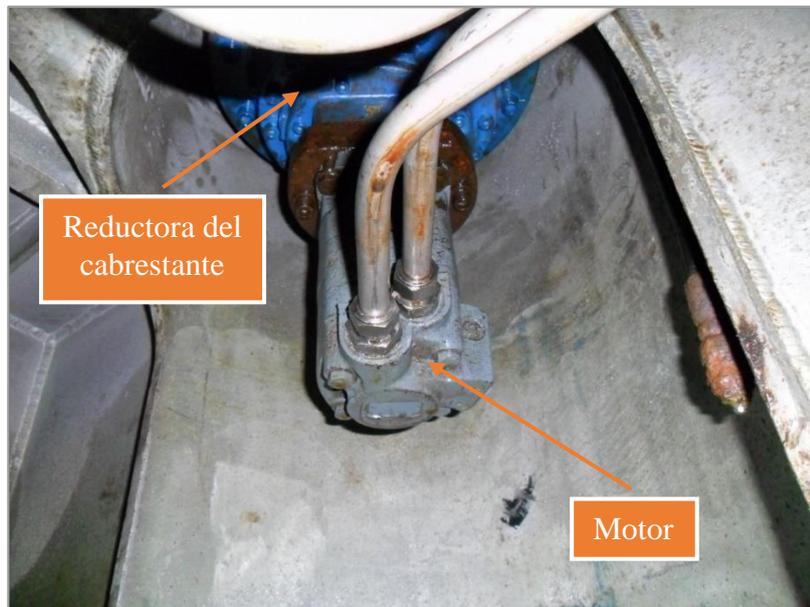
*Ilustración nº 105: Motor hidráulico y reductora del cabrestante.
