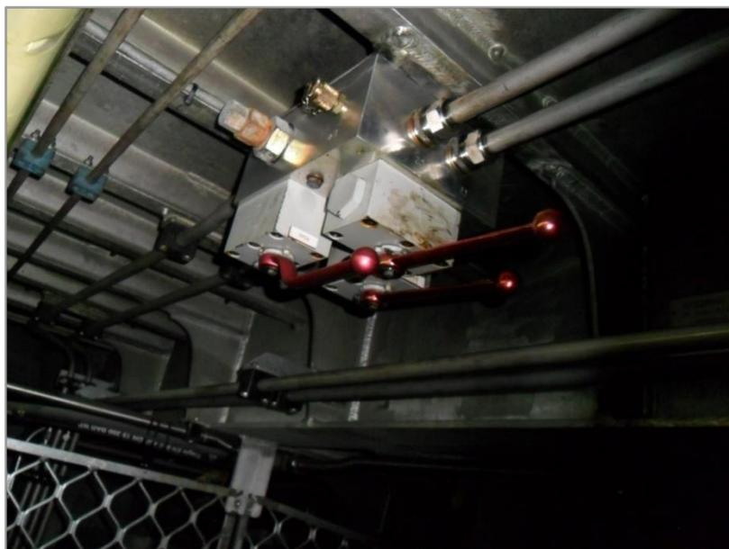
*Ilustración nº 81: Bloque situado ante de los cilindros del steering.
