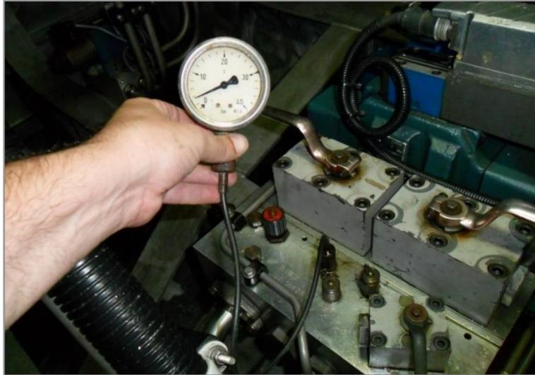
*Ilustración n° 118: Ejemplo de una medida de presión.
