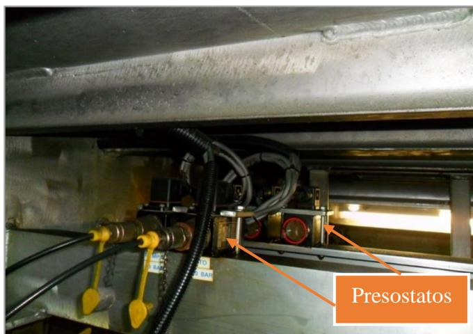
*Ilustración n° 68: Presostatos del bloque de distribución.
