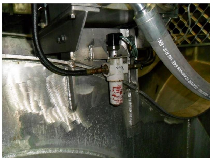
*Ilustración n° 98: Filtro del bloque del trim-tab.
