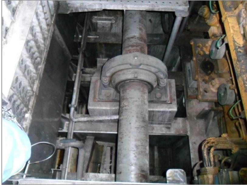
*Ilustración n° 16: Eje apoyado en cojinete.
