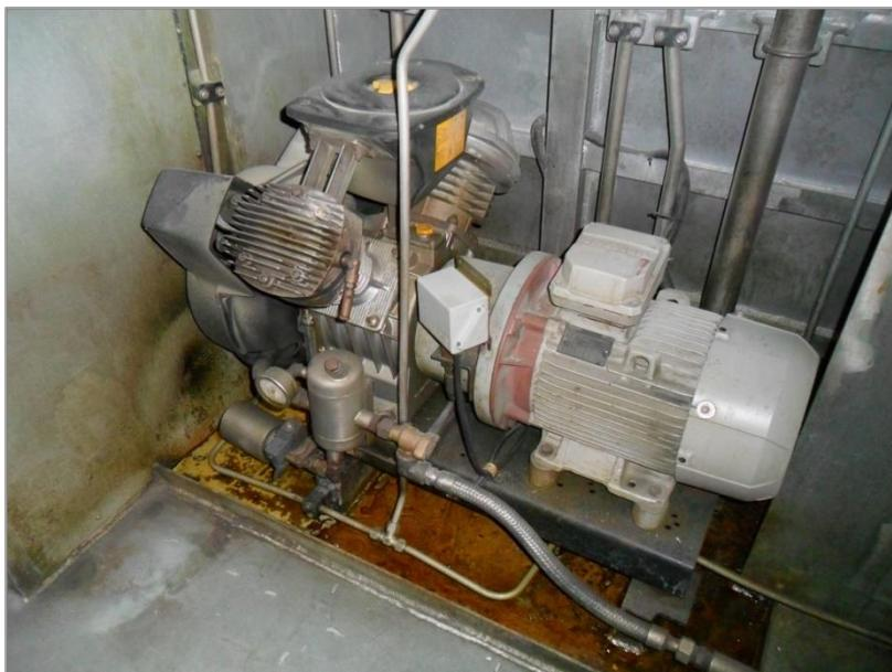
*Ilustración n° 26: Compresor de aire.
