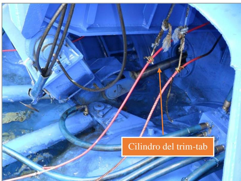
*Ilustración n° 94: Cilindro del trim-tab visto desde fuera.
