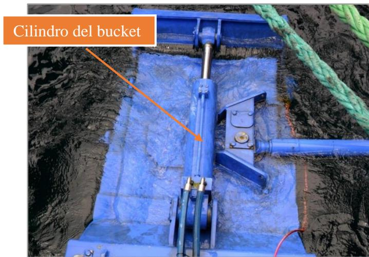
Ilustración n° 86: Cilindro del bucket.
