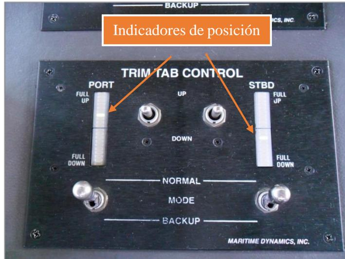
Ilustración n° 95: Control del trim-tab con indicadores de posición.
