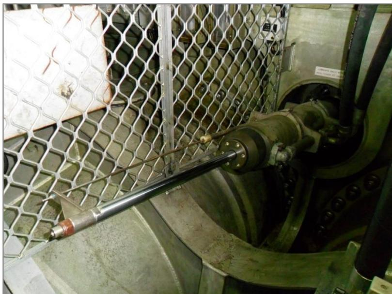
*Ilustración n° 93: Cilindro del trim-tab visto desde el jet-room.
