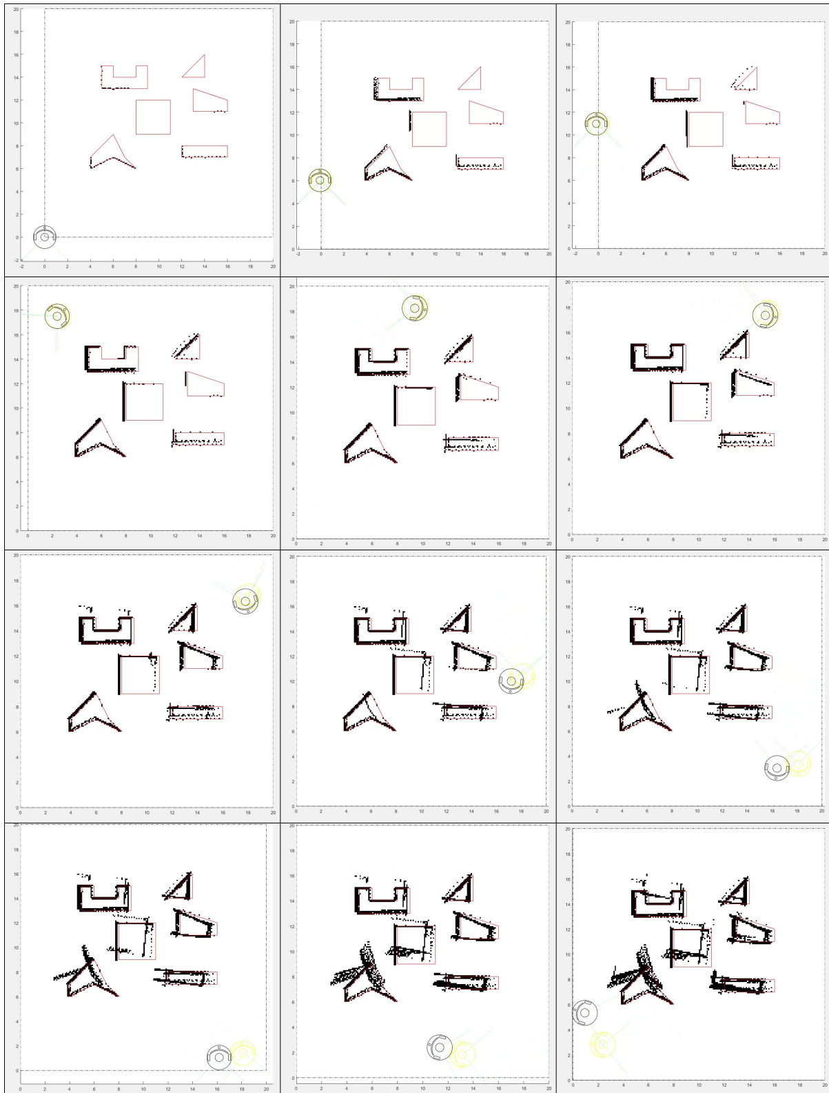
Figura A.9: Resultado de MappingTB_v5_1 con error de odometría. Obstáculos en rojo, mapa en negro, pose real en amarillo y pose calculada en negro.
