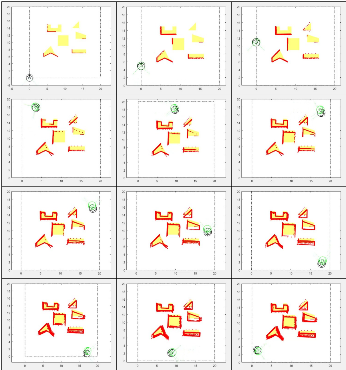
Figura A.6: Resultado de MappingTB_v4 con error de odometría. Obstáculos en amarillo, mapa en rojo, pose real en verde y pose calculada en negro.
