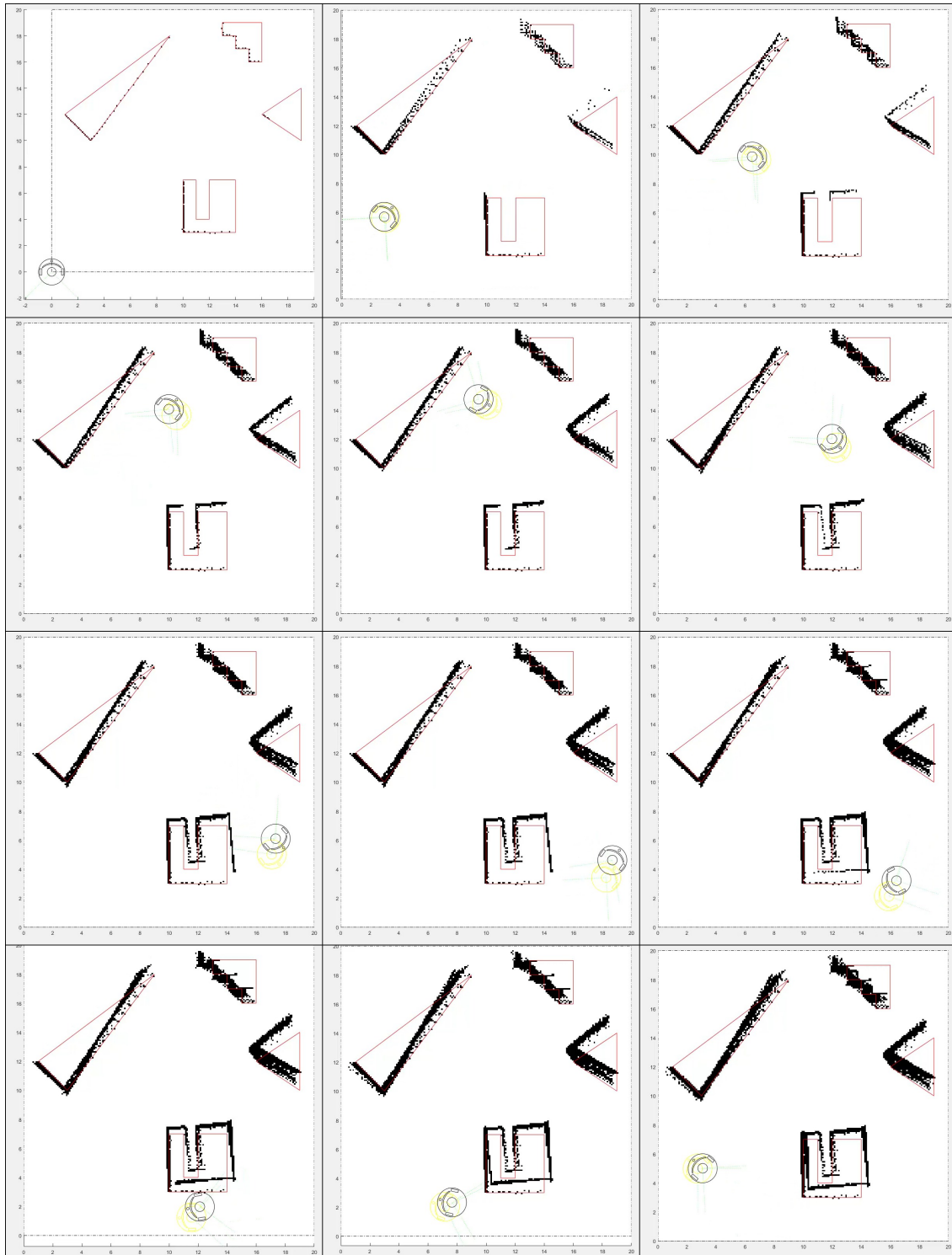
Figura A.11: Resultado de MappingTB_v5_2 con error de odometría. Obstáculos en rojo, mapa en negro, pose real en amarillo y pose calculada en negro.
