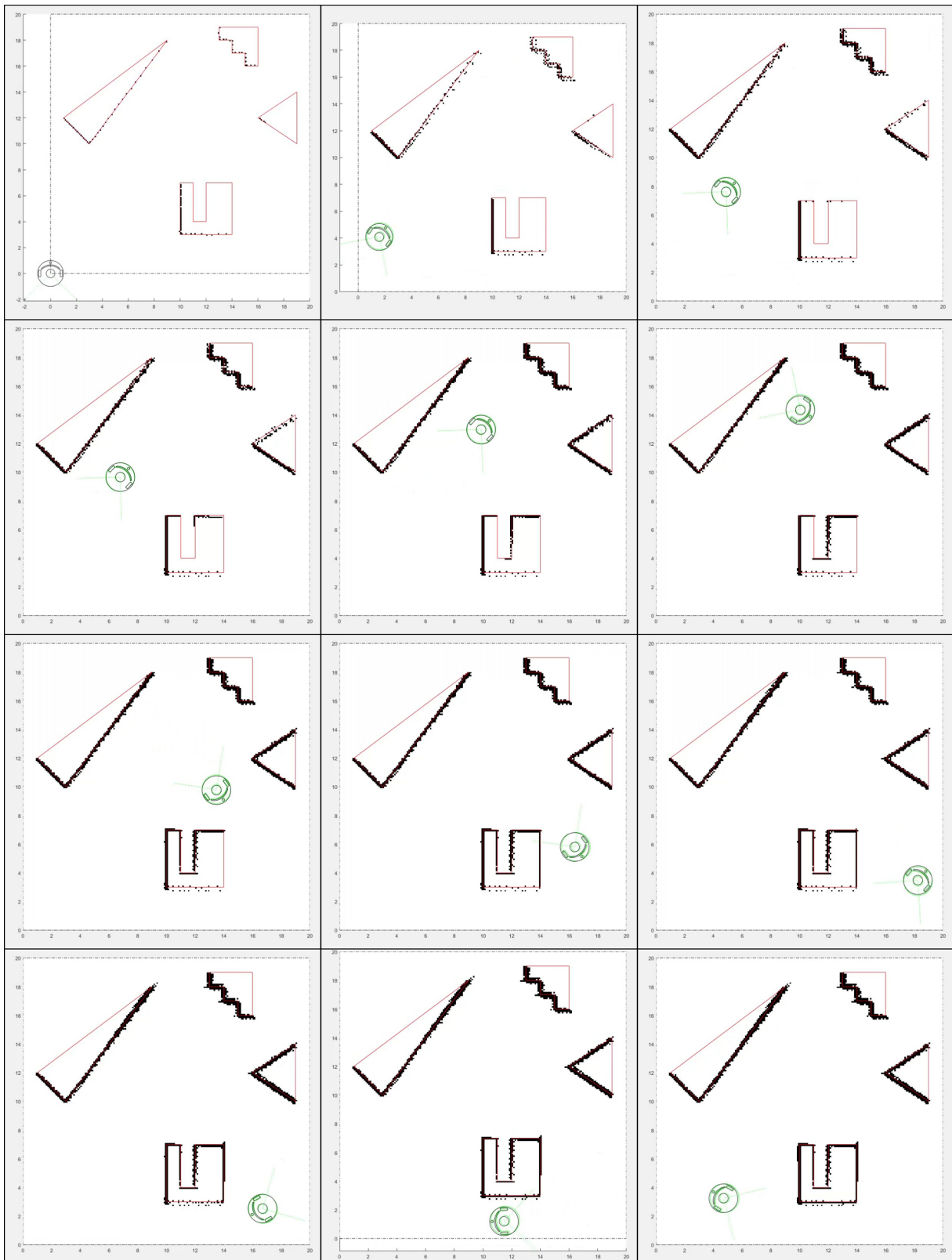
Figura A.24: Resultado de MappingTB_v6_2 con error de odometría 0,3. Obstáculos en rojo, mapa en negro, pose real en verde y pose calculada en negro.
