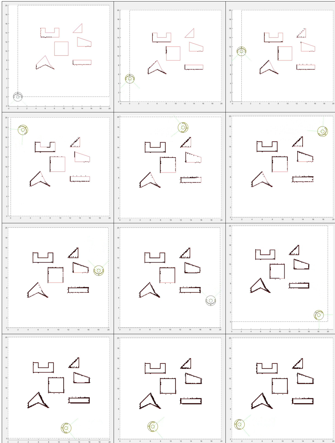
Figura A.12: Resultado de MappingTB_v6_1 con error de odometría 0,5. Obstáculos en rojo, mapa en negro, pose real en amarillo y pose calculada en negro.
