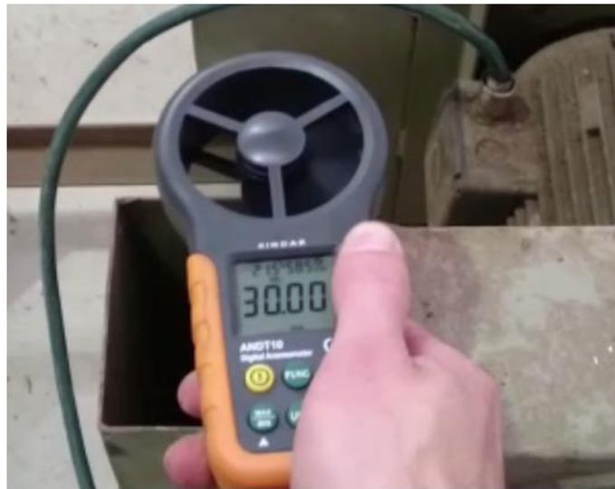
Figura 1- Medida de la velocidad del ventilador
