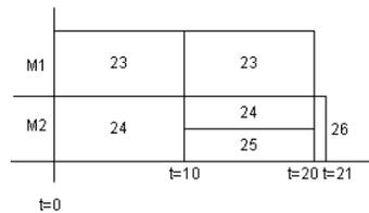
Figura A.1: Aplicación del algoritmo de Muntz y Coffman para  $P2|pmtn,intree|C_{max}$  usando procesador compartido para el problema del ANTES en  $S_2$
