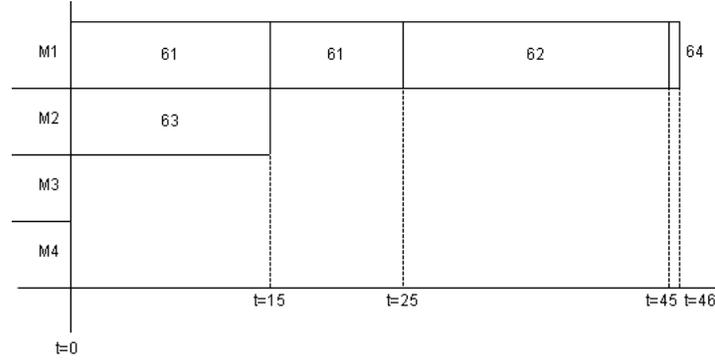
Figura 4.17: Solución propuesta por el algoritmo de Muntz y Coffman para  $P4|pmtn,intree|C_{max}$  para el problema del DESPUÉS en  $S_3$
