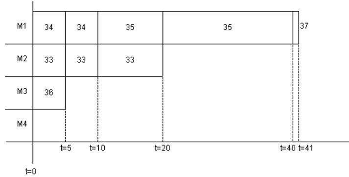
Figura 4.15: Solución propuesta por el algoritmo de Muntz y Coffman para  $P4|pmtn,intree|C_{max}$  para el problema del ANTES en  $S_3$
