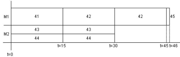
Figura 4.11: Aplicación del algoritmo de Muntz y Coffman para  $P2|pmtn,intree|C_{max}$  usando procesador compartido para el problema del DESPUÉS en  $S_1$
