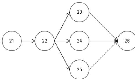
Figura 3.8: Grafo  $G_a^{S_2} = (V_a^{S_2}, A_a^{S_2})$  que modeliza las relaciones de precedencia de los trabajos del ANTES en sección  $S_2$  de la actividad comercial de abastecimiento de víveres
