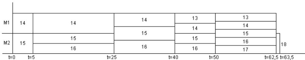
Figura 4.9: Aplicación del algoritmo de Muntz y Coffman para  $P2|pmtn,intree|C_{max}$  usando procesador compartido para el problema del ANTES en  $S_1$
