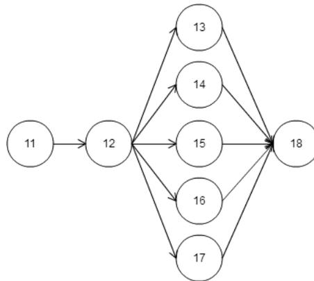
Figura 3.7: Grafo  $G_a^{S_1} = (V_a^{S_1}, A_a^{S_1})$  que modeliza las relaciones de precedencia de los trabajos del ANTES en la sección  $S_1$  de la actividad comercial de abastecimiento de víveres
