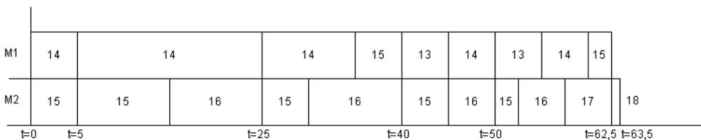
Figura 4.10: Solución propuesta por el algoritmo de Muntz y Coffman para  $P2|pmtn,intree|C_{max}$  ya reconvertida a una solución factible óptima sin usar procesador compartido para el problema del ANTES en  $S_1$
