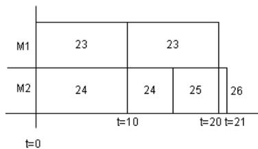
Figura 4.13: Solución propuesta por el algoritmo de Muntz y Coffman para  $P2|pmtn,intree|C_{max}$  ya reconvertida a una solución factible óptima sin usar procesador compartido para el problema del ANTES en  $S_2$
