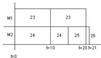
Figura A.2: Solución propuesta por el algoritmo de Muntz y Coffman para  $P2|pmtn,intree|C_{max}$  ya reconvertida a una solución factible óptima sin usar procesador compartido para el problema del ANTES en  $S_2$
