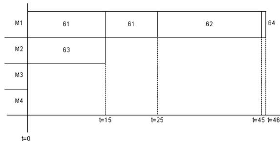
Figura A.5: Solución propuesta por el algoritmo de Muntz y Coffman para  $P4|pmtn,intree|C_{max}$  para el problema del DESPUÉS en  $S_3$
