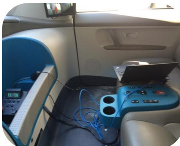
Figura 2.15. Interior del coche de Google. Botón de parada de emergencia.
