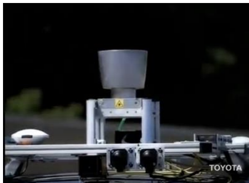
Figura 3.4.7. LIDAR de un coche en pruebas de Toyota
