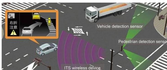
Figura 3.4.4. Comunicaciones ITS entre coches e infraestructuras
