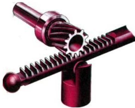
Figura 4.6 Detalle piñon-cremallera de la caja de dirección
