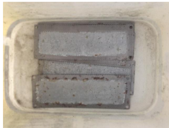
Figura XXXVIII. Placas de apoyo en acetona.
