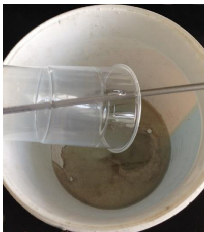
Figura XXIX. Vertido de materias primas en recipiente para amasada.
