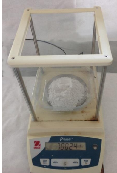
Figura XXVII. Pesada del grano <63\mu\text{m} , Serie 2.
