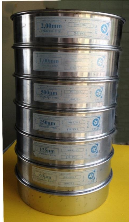
Figura XX. Disposición de tamices.
