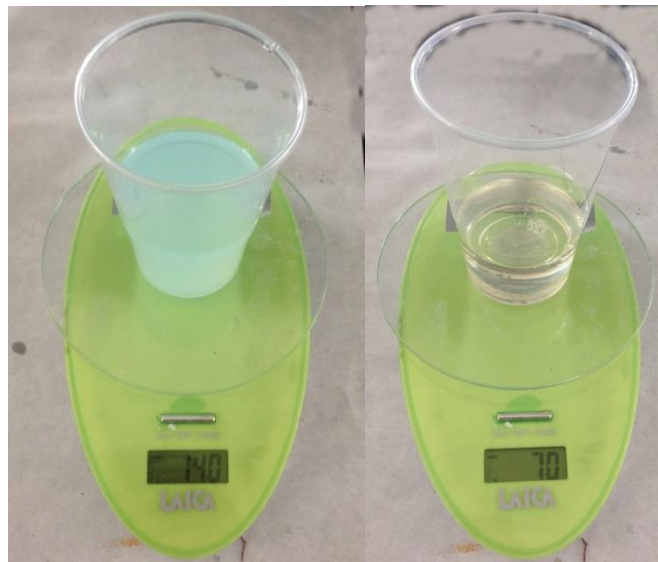
Figura XXVIII. Pesada de la resina epóxica y el catalizador, Serie 2.
