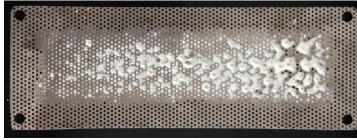
Figura XXXVI. Placa de apoyo Molde 3, filtración de la resina.
