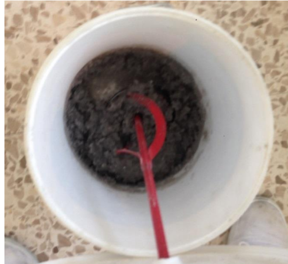
Figura XXX. Proceso de amasado con mezclador.
