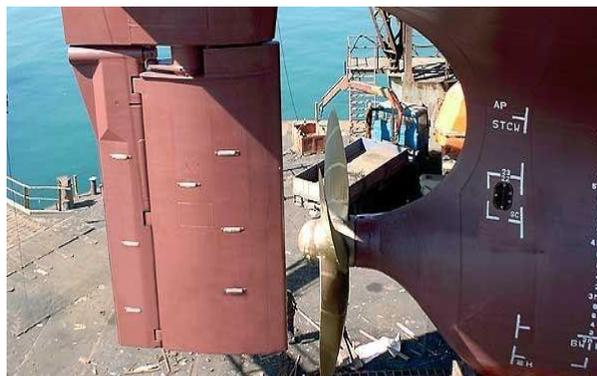
Foto 19: Timón Becker (Timón articulado). Fuente: [http://img.nauticexpo.es/images\\_ne/photo-g/timon-aleta-buques-30793-178335.jpg](http://img.nauticexpo.es/images_ne/photo-g/timon-aleta-buques-30793-178335.jpg)
