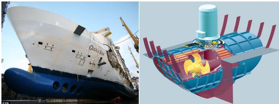
Foto 15 y foto 16: Hélice de proa y esquema de una hélice de proa. Fuente:
