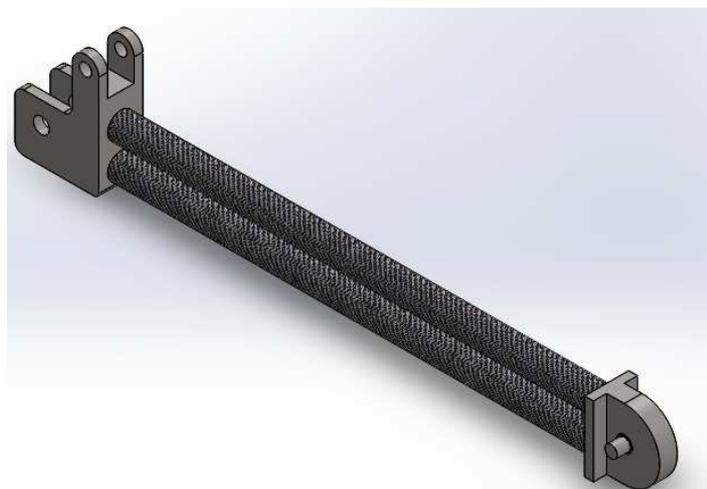
**Figura 10. Modelo inicial de fibra de carbono con rótulas metálicas**
