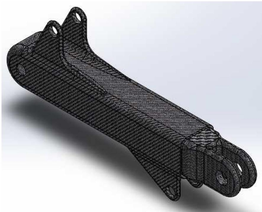
Figura 11. Modelo integro en fibra de carbono.
