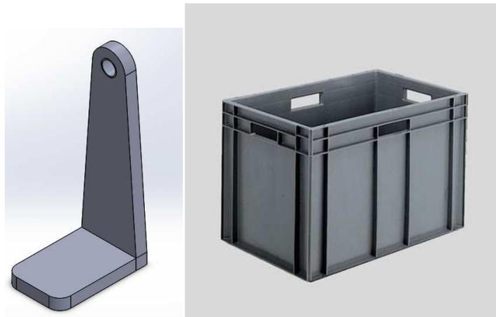
**Figura 25. A la izquierda, modelo final metálico de la pala para el enganche de la carga; a la derecha, modelo de caja a levantar mediante el brazo.**
