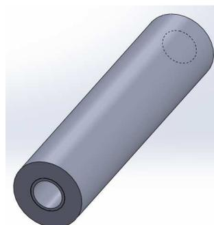
**Figura 22. Modelo final metálico, vástago auxiliar que une los dos enganches que soportan el reposabrazos.**
