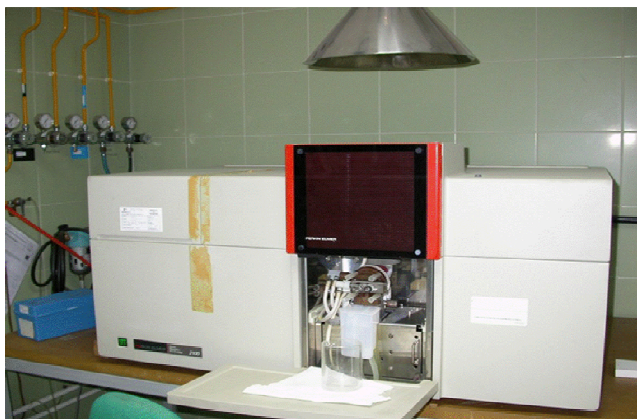
Figura 31. Espectrofotómetro de absorción atómica con llama.
