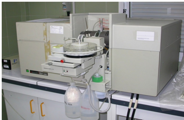
Figura 32. Espectrofotómetro de absorción atómica con cámara de grafito.
