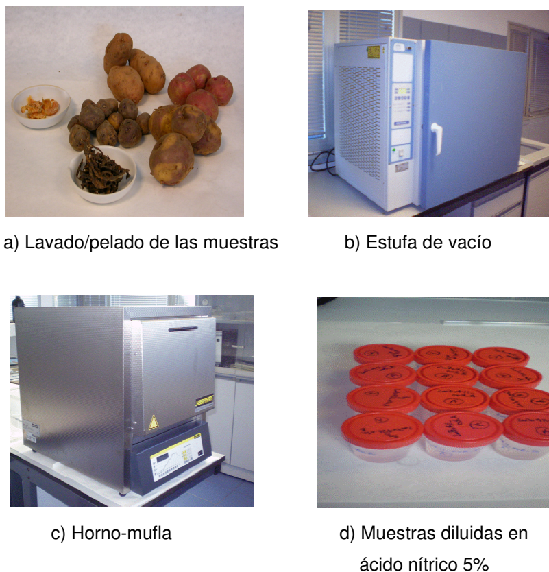
Figura 30. Esquema del proceso de preparación y tratamiento de las muestras.
