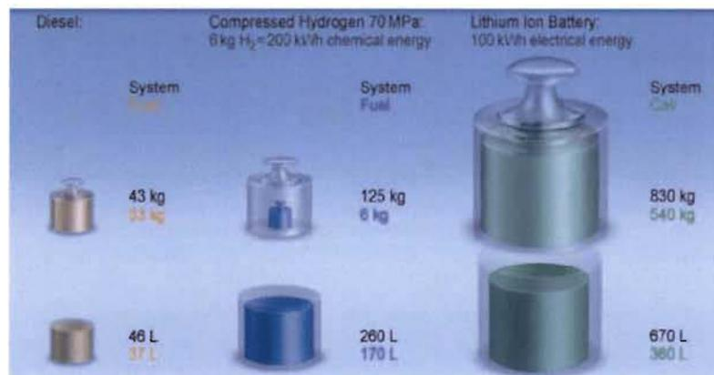
**Figure 1.1 : La masse et le volume de systèmes pouvant être utilisés dans l'industrie automobile pour une autonomie de 500km[4].**
