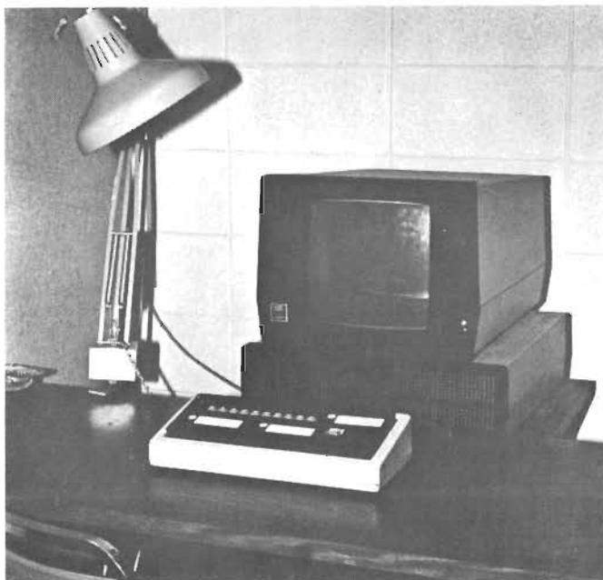
Fig. 1 - Terminal et clavier PLATON
