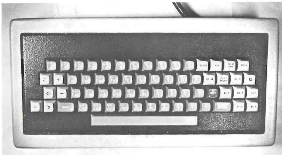
Fig. 2 - Clavier du terminal PLATON
