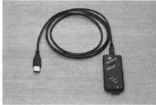
Figure 5. 7 PICkit2 avec câble USB
