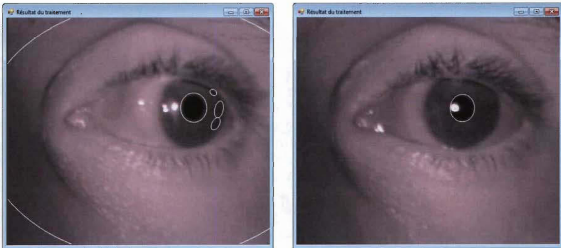
Figure 60 Sélection de l'ellipse qui est la pupille. Gauche : avant élimination. Droite : après élimination.
