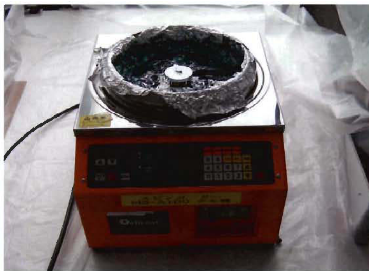
Figure 3.3 : Dépôt de 60 nm de PEDOT : PSS par spin coating et image de l'appareil utilisé pour la mise en forme des films minces en solution.
