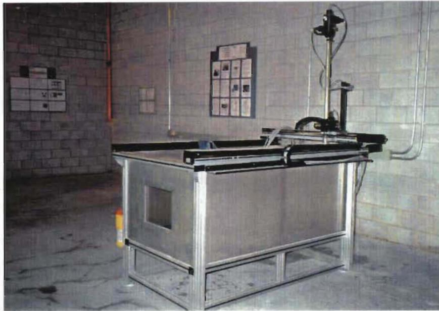
**Fig. 5.22** Système d'inspection par ondes de volume sur bain à immersion.
