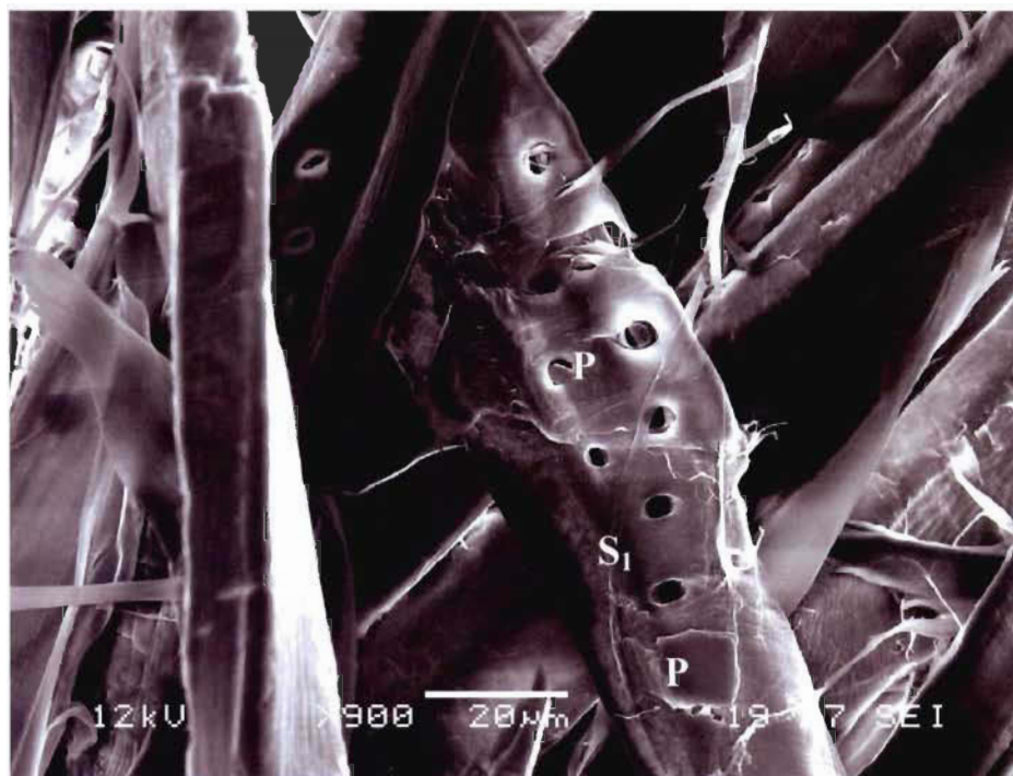
Figure 6.51 Surface des fibres de la fraction R28, de la pâte QBC (CSF de la pâte = 100 mL)
