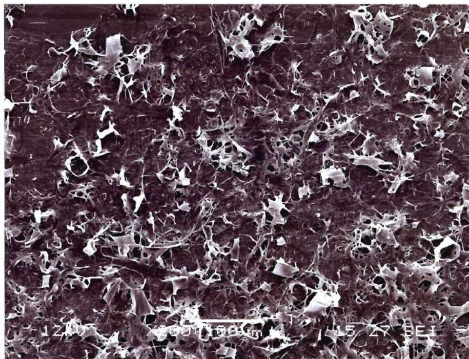
Figure A-0.4 Vue générale des fines (P200) de la pâte Q2 (CSF de la pâte = 100 mL)
