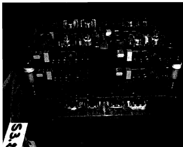
a) Ensemble des deux onduleurs monophasés avec la commande rapprochée des interrupteurs
