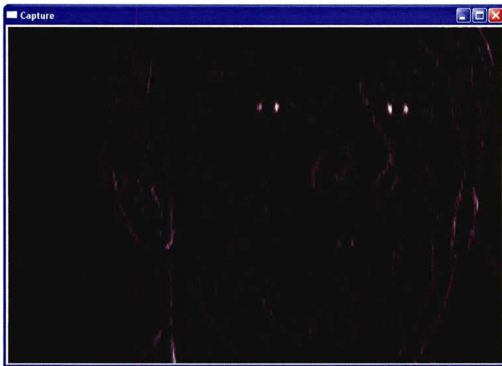
Figure 3.3 Image montrant un exemple de prétraitement avec l'application du filtre de Sobel de second ordre en X et nulle en Y avec une fenêtre de convolution de 5 pixels.
