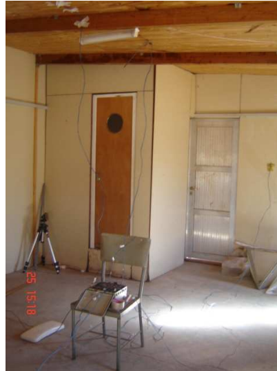
Figura 4. Disposición de termocuplas en el interior
