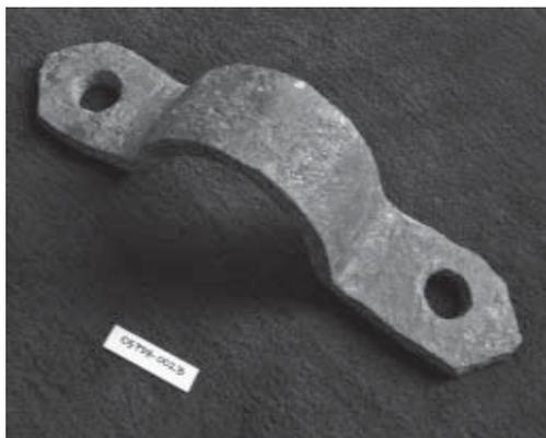
Figura 8. Réplica con resina epoxy de la pieza de la concreción 05 PDH - 002 b. Herraje en omega con dos orificios pasantes en los extremos; posiblemente utilizado para asegurar los muñones de un cañón a la cureña (fotografía: Cristian Murray).
