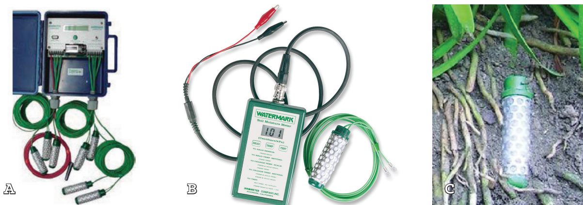
Figura 9.3 – Dispositivos de leitura e armazenamento de dados ( A e B ) de sensor de matriz granular (WaterMark) com elétrodos envolvidos em quartzo e gesso ( C ). Fonte: http://www.irrometer.com
