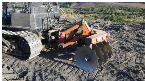
Figura 4.6 – Grade de discos. Grada de discos.
