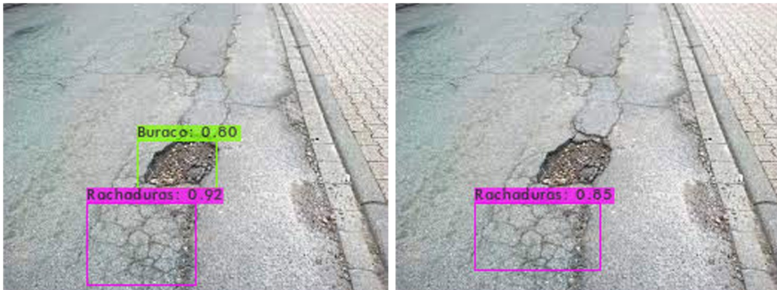
Figura 40 - Teste com imagens de rachaduras e buracos com baixa resolução, sendo (a) Yolov3 e (b) Yolov4.
