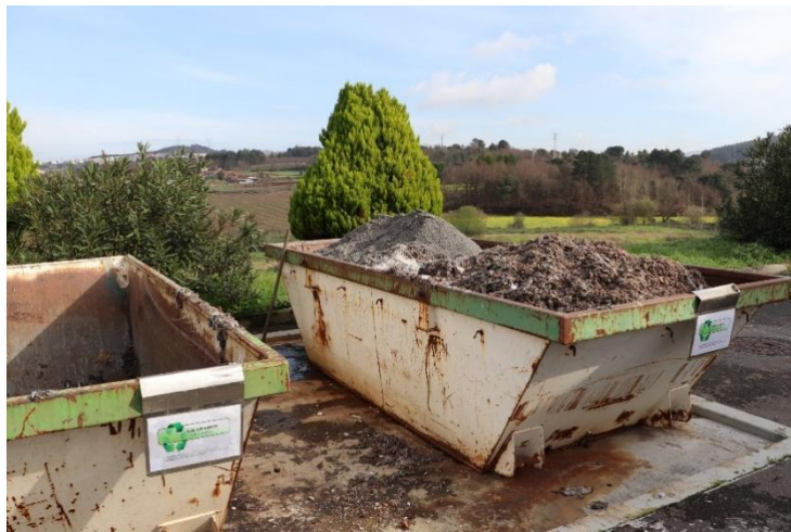
Figura 16: Areia e materiais grosseiros removidos do efluente.
