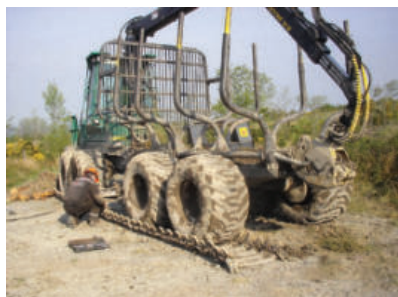
Figura 43: Fasi relative al montaggio dei semi-cingoli
