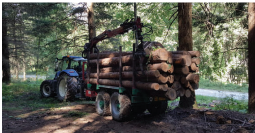
Figura 12: Esbosco di tondeame di medie e grandi dimensioni con trattore e rimorchio equipaggiato di gru idraulica
