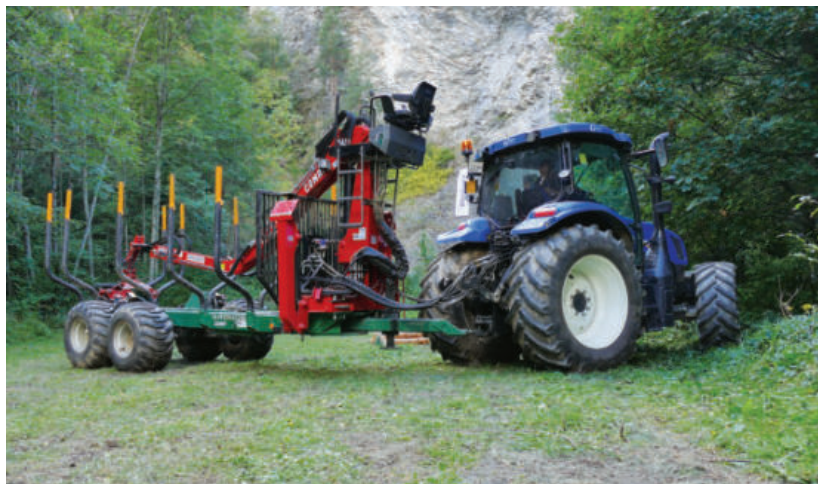
Figura 41: Trattore e rimorchio forestale a 8 ruote (4 attrice e 4 rimorchio) con una maggiore superficie di contatto a terra ed una minore pressione al suolo rispetto al trattore e rimorchio forestale a 6 ruote
