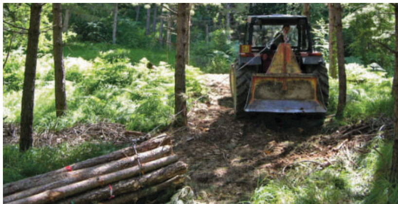
Figura 8: Operazioni di concentrazione del legname a strascico con trattore e verricello
