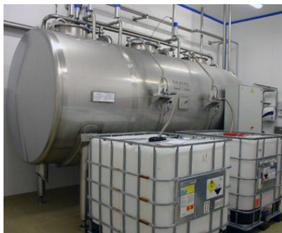
Figura 79: Ilustración de un tanque cisterna para la distribución de la leche cruda.
