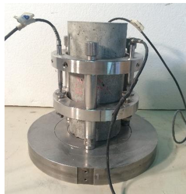
Figura 3.4 – Configuración del ensayo de módulo de elasticidad
