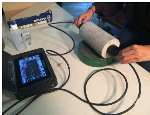
Figura 3.3 – Realización de medidas de velocidad ultrasónica en probetas de HRF
