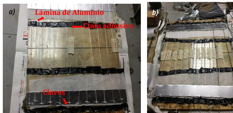
Figura 7.7 – Colocación de las láminas de aluminio sobre las fibras a). Lámina de vidrio adherida a la muestra en los extremos b).
