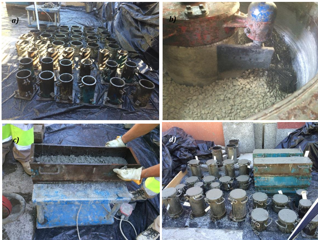
Figura 3.1 –Proceso de fabricación del hormigón: Colocación de moldes a). Incorporación de las fibras b). compactación de probeta en mesa vibrante c). Probetas fabricadas d).
