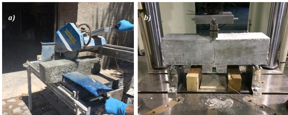
Figura 3.6 – Entalla de una probeta prismática a), probeta prismática ensayada b).
