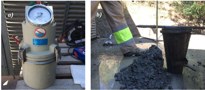
Figura 3.2 – Ensayos en estado fresco del HRF: aire ocluido a). trabajabilidad b)
