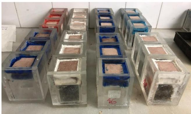
**Imagen 17.** Ensayo de permeabilidad al vapor de agua. Fuente: Elaboración propia.
