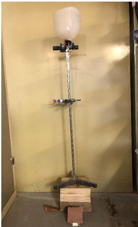
**Imagen 19.** Instrumental para ensayo de erosión acelerada Swinburne. Fuente: Elaboración propia.
