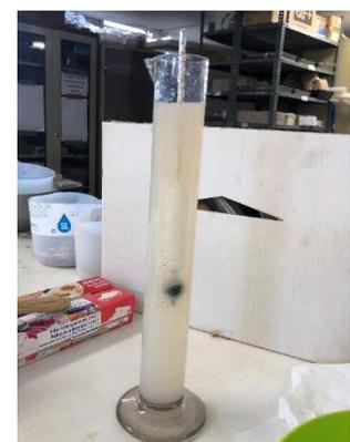
**Imagen 8.** Determinación de densidad en laboratorio. Fuente: Elaboración propia.
