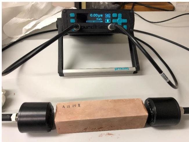
**Imagen 12.** Equipo de ultrasonidos para ensayo de Módulo de Young dinámico. Fuente: Elaboración propia.
