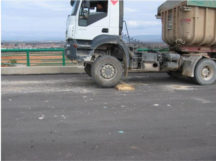
*Fig 2. Fotografía de prueba de carga dinámica, paso de un camión sobre tablero.*
