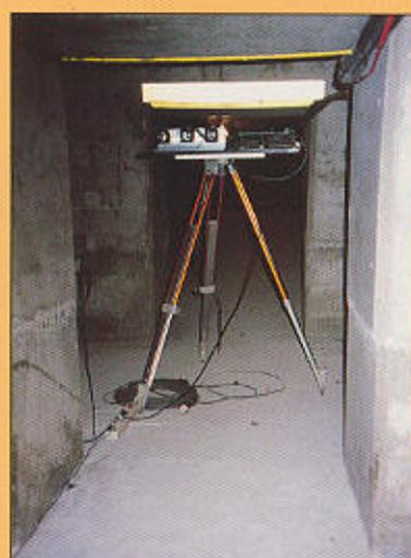
Equipos láser utilizados en las pruebas de carga del viaducto sobre el Ebro en Amposta.
