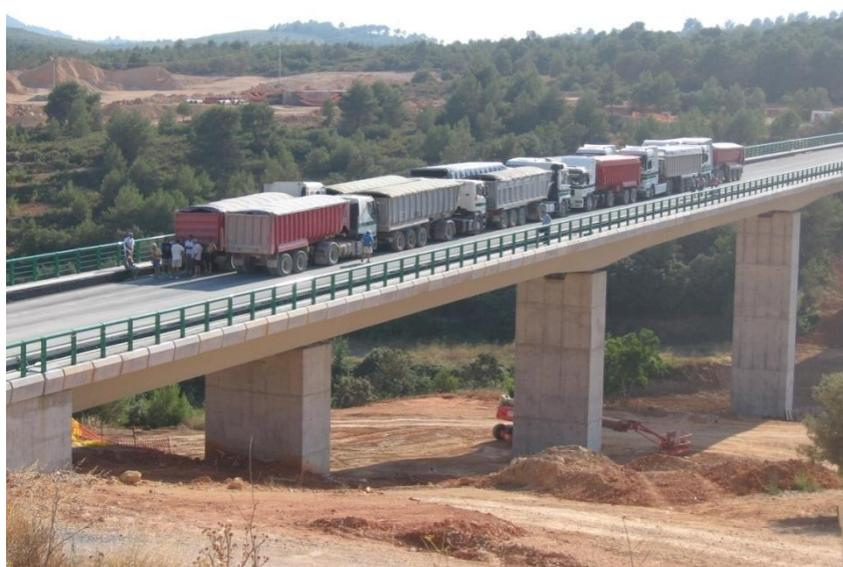
*Fig. 9. Estado de carga asimétrico. Viaducto Papán. LAV - Levante.*
