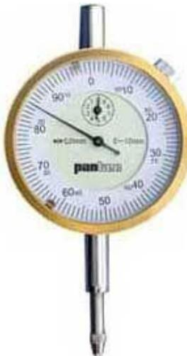
Fig.22. Reloj comparador mecánico
