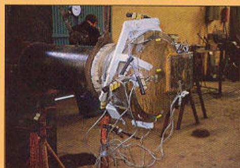
Instrumentación mediante bandas extensométricas de una válvula de cierre de conducción de gas.
