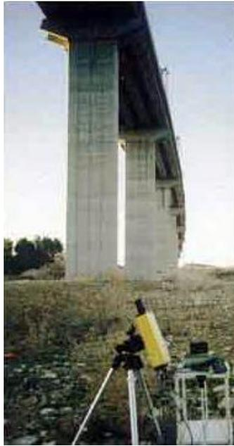
*Fig. 23. Sistema de medida de flechas con láser (Intemac).*
