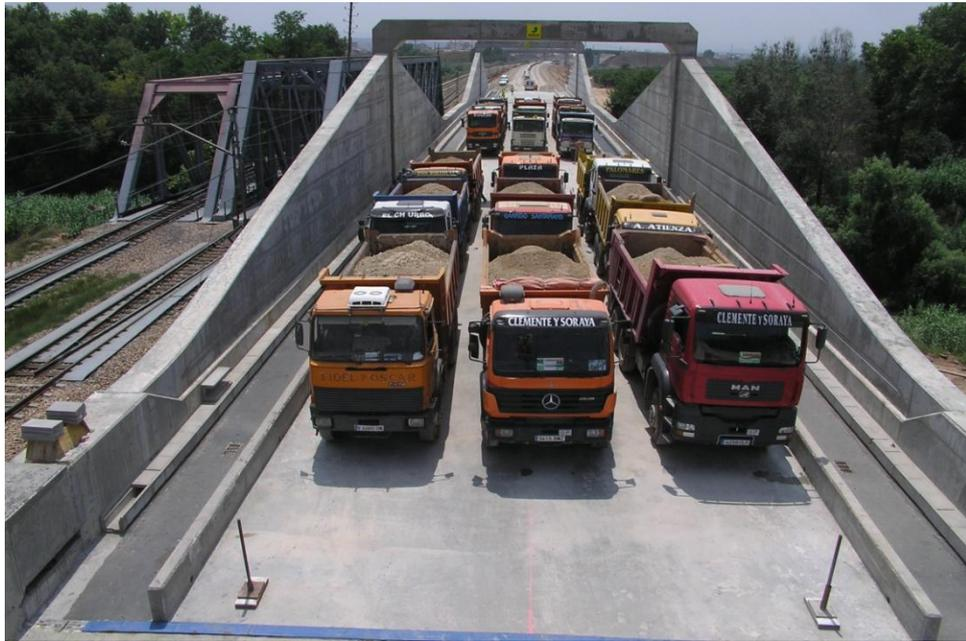
*Fig. 8. Viaducto del Júcar, cargado de forma uniforme.*
