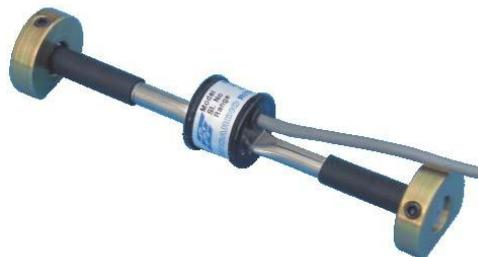
*Fig. 18. Extensómetro de cuerda vibrante (Encardio)*
