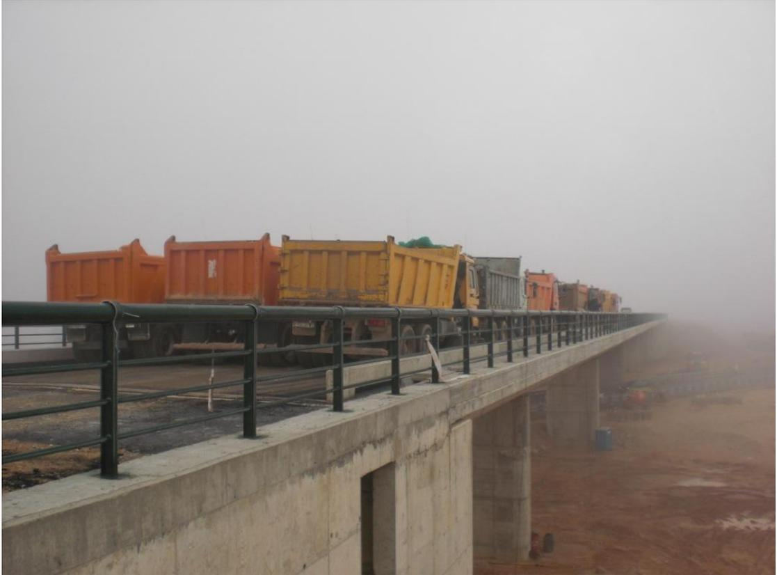
*Fig. Anexo D 1. Viaducto cargado en Hipótesis de carga 1 (cargado vano 1 y 3)*
