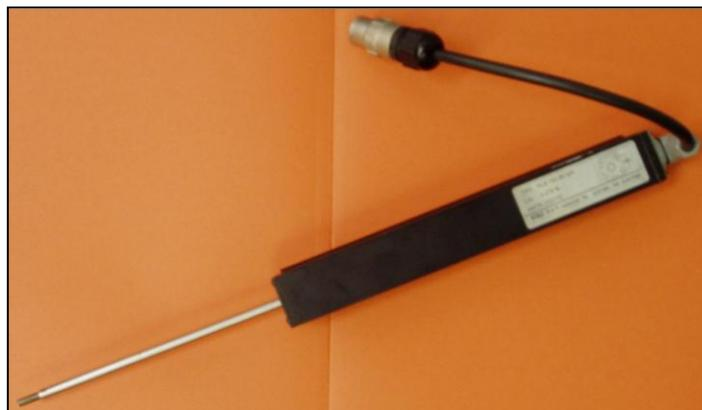
Fig.29. Transductor de desplazamiento ELAP
