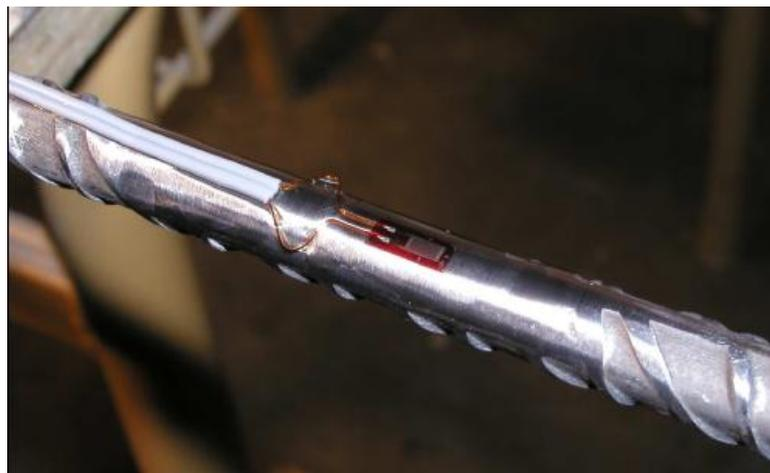
*Fig. 17. Banda extensométrica colocada en una barra longitudinal*
