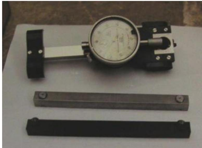
*Fig. 15. Extensómetro mecánico*
