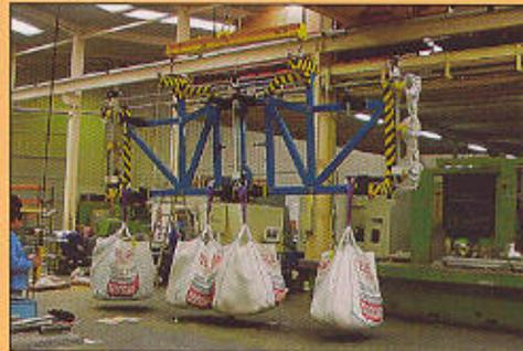
Prueba de carga del útil empleado en el izado del estabilizador de los aviones Airbus A-340/500/600.
