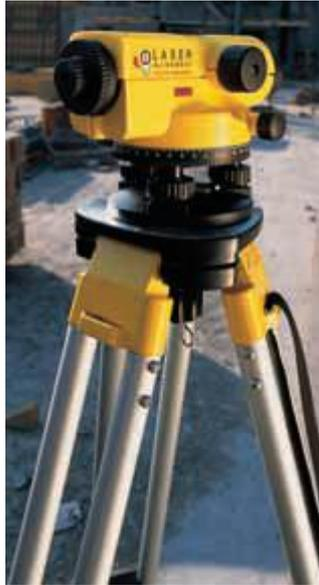
Fig.21. Nivel topográfico.
