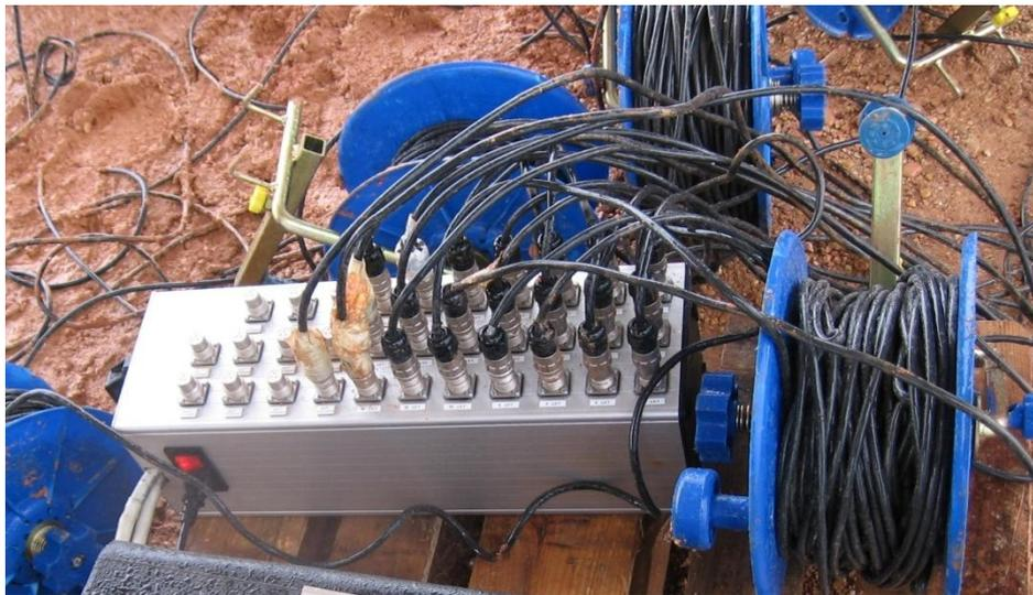
*Fig. 30. Caja de conexiones de 32 canales y bobinas de cable*
