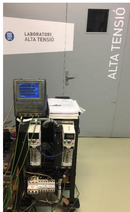
Fig. 10 Sistema Electrónico Regenerativo con volante de inercia y osciloscopio de registro, en los laboratorios de alta tensión de la ETSEIB, UPC, Barcelona.
