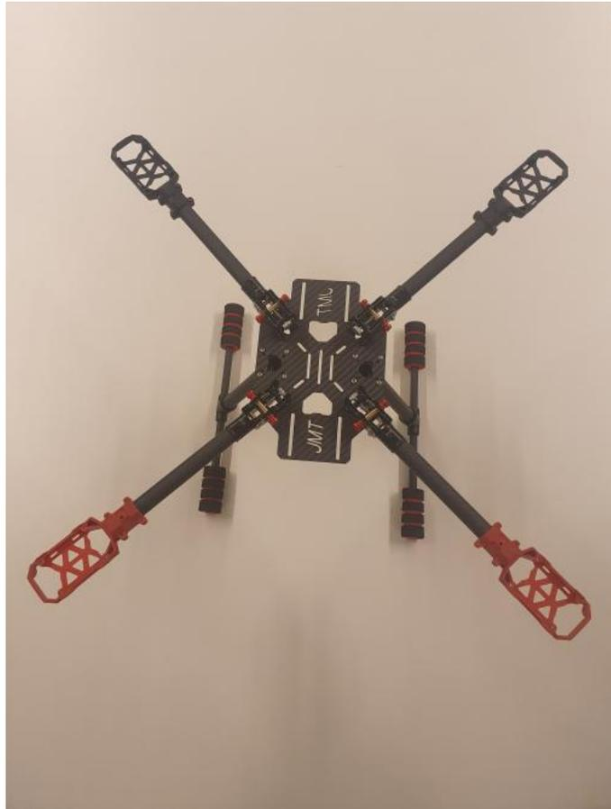
**Figura 3.15:** Frame con el tren de aterrizaje ensamblado
