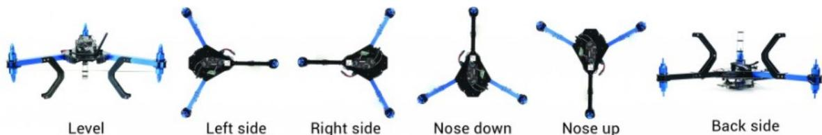
**Figura 3.24:** Posiciones de calibración de el acelerómetro
