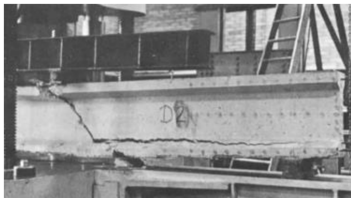
Figura 4.1.4: Fallo por cortante (Arthur 1965)
