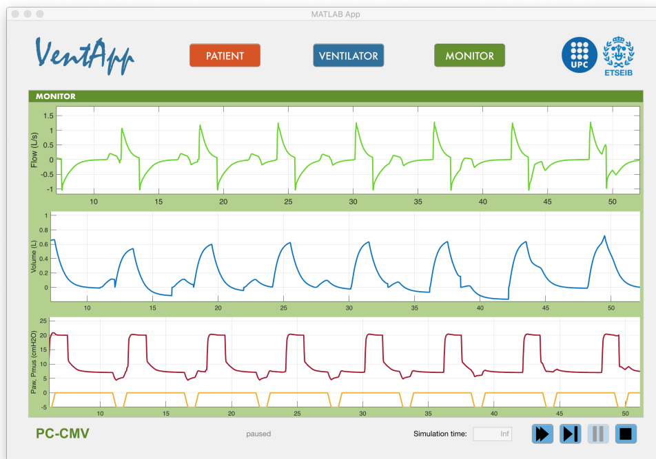
Fig. 4.3: Curvas de flujo, volumen y presión en la vía aérea obtenidas del simulador desarrollado en el modo PC-CMV [elaboración propia]
