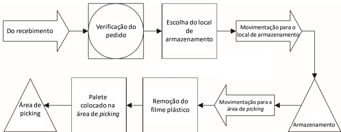
Figura 3 - Etapas de desmembramento de carga no armazém, desde o recebimento do produto até sua alocação na área de picking
