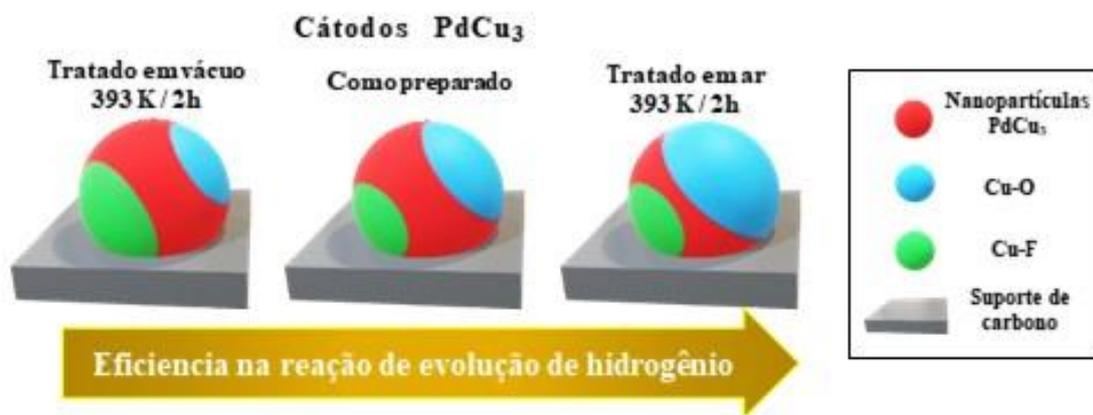
**Figura 34** – Esquema da eficiência dos cátodos PdCu<sub>3</sub> na reação de evolução de hidrogênio em função do tratamento térmico aplicado.
