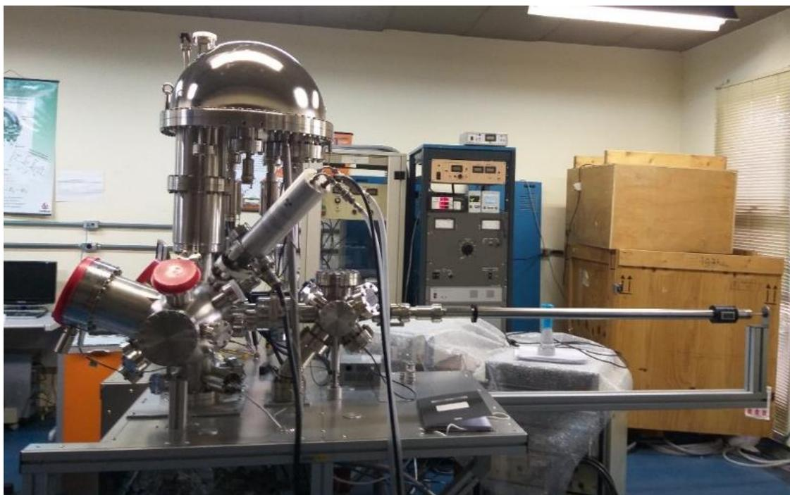
**Figura 7** - Sistema SPECS do Laboratório de Espectroscopia de Elétrons, equipado com fonte de radiação 04-548 Dual Anode X-Ray Source (PERKIN-ELMER) e analisador de elétrons SPECS PHOIBOS 150, em que as medidas de XPS foram realizadas.
