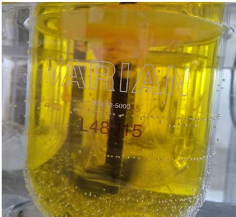
Figura 20. Cuba com meio de dissolução com tensoativo CPC 5% e tampão fosfato 25 mM pH 7,4 para ensaio de dissolução de NTZ em suspensão oral no tempo de 45 minutos.
