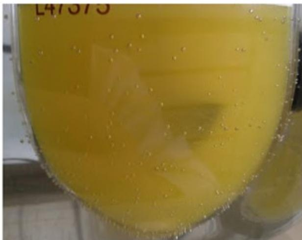
Figura 15. Cuba com meio de dissolução com SDS 6% para ensaio de dissolução de NTZ em suspensão oral.
