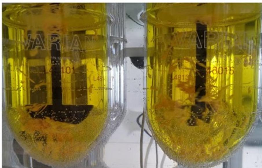
Figura 19. Cuba com meio de dissolução com tensoativo CPC 5% e tampão fosfato 25 mM pH 7,4 para ensaio de dissolução de NTZ em suspensão oral em tempo zero.
