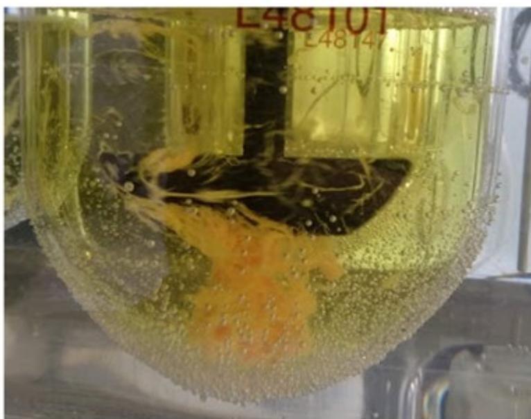
Figura 17. Cuba com meio de dissolução com CPC 3% para ensaio de dissolução de NTZ em suspensão oral.
