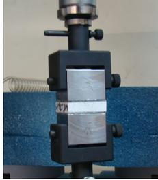
**Figura 1-** Ensaio de resistência à tração nas faces para os compósitos estruturais sanduíche.
