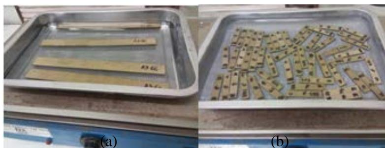
**Figura 1** – Compósito no interior do banho térmico sob placa aquecedora durante a sorção de água. (a) Amostra usada para o ensaio de tração e (b) amostra usada para o ensaio de flexão.
