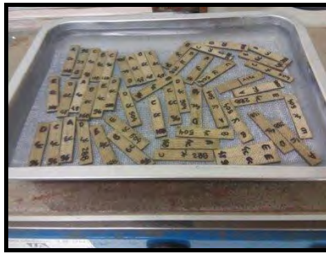
Figura 2: Amostras no interior do banho térmico durante a sorção de água.
