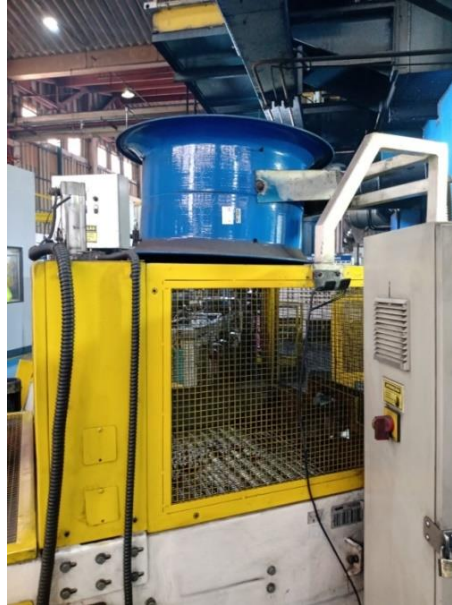
Figura 19: Imagem do sistema de resfriamento controlado. Acima da esteira está posicionado o ventilador que aplica as duas taxas de resfriamento para as condições de rotação de 30 70 Hz do mesmo.
