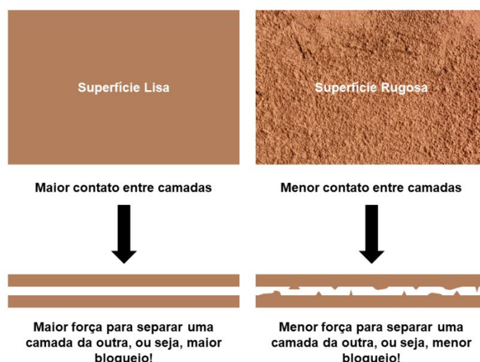
Figura 2 – Esquema da atuação do aditivo antibloqueio.
