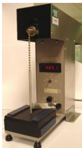
Figura 7 – Equipamento para medição de bloqueio.
