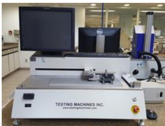
Figura 6 – Equipamento para medição do coeficiente de fricção (TMI).
