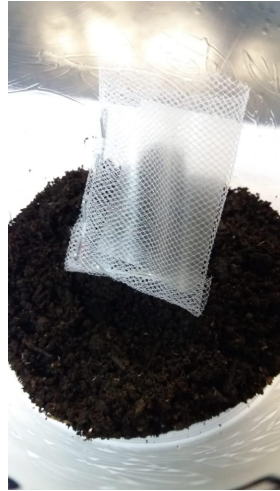
Figura 17 - Amostras em redes de nylon e ensaio de degradação em solo
