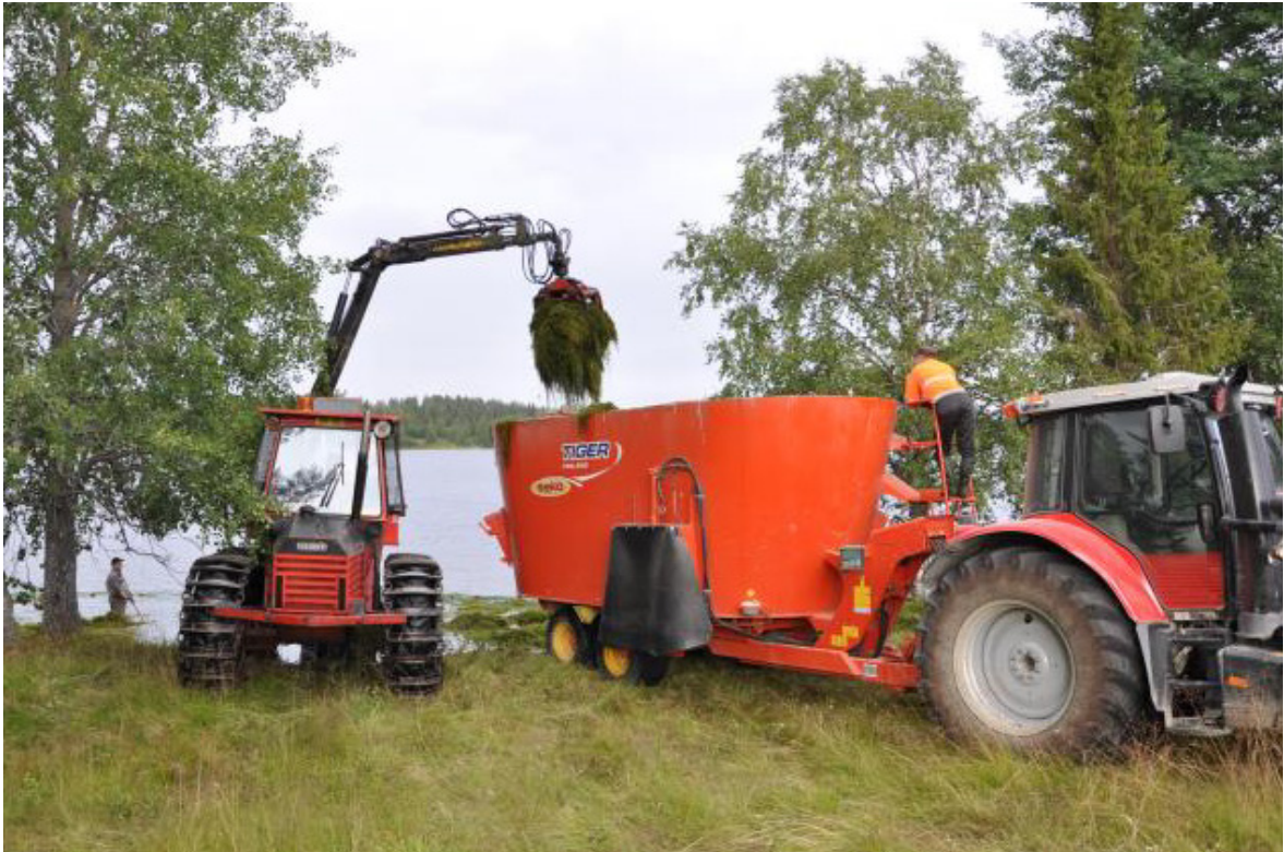
Kuva 15. Vesiruton kuormausta metsäkoneella apevaunuun. Kuva Timo Lötjönen, Luke.
