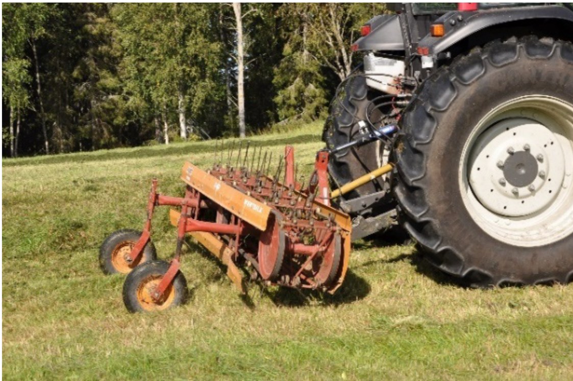
Kuva 23. Ketjuharavapöyhin. Kuva Timo Lötjönen, Luke.
