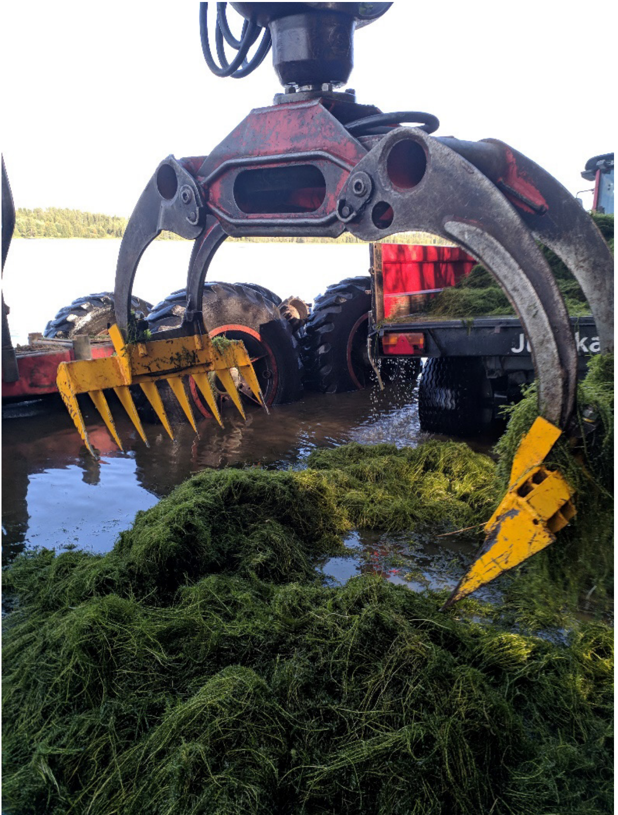
Kuva 6. Metsäkoneen kahmariin rakennettu lisäosa vesiruton kokoamiseen ja kuormaamiseen. Kuva: Ritva Nilivaara, SYKE.
