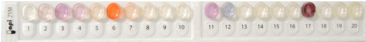
Kuva 39. Entsyymiaktiivisuuden mittausta API ® ZYM-testimenetelmällä. Tuloksen perusteella testattu isolaatti tuottaa fosfataasi- (2, 11, 12), esteraasi- (3,4), aminipeptidaasi- (6, 7) ja glykosyylhydrolaasi- (17) entsyymejä. Kuva: Lea Hiltunen, Luke.
