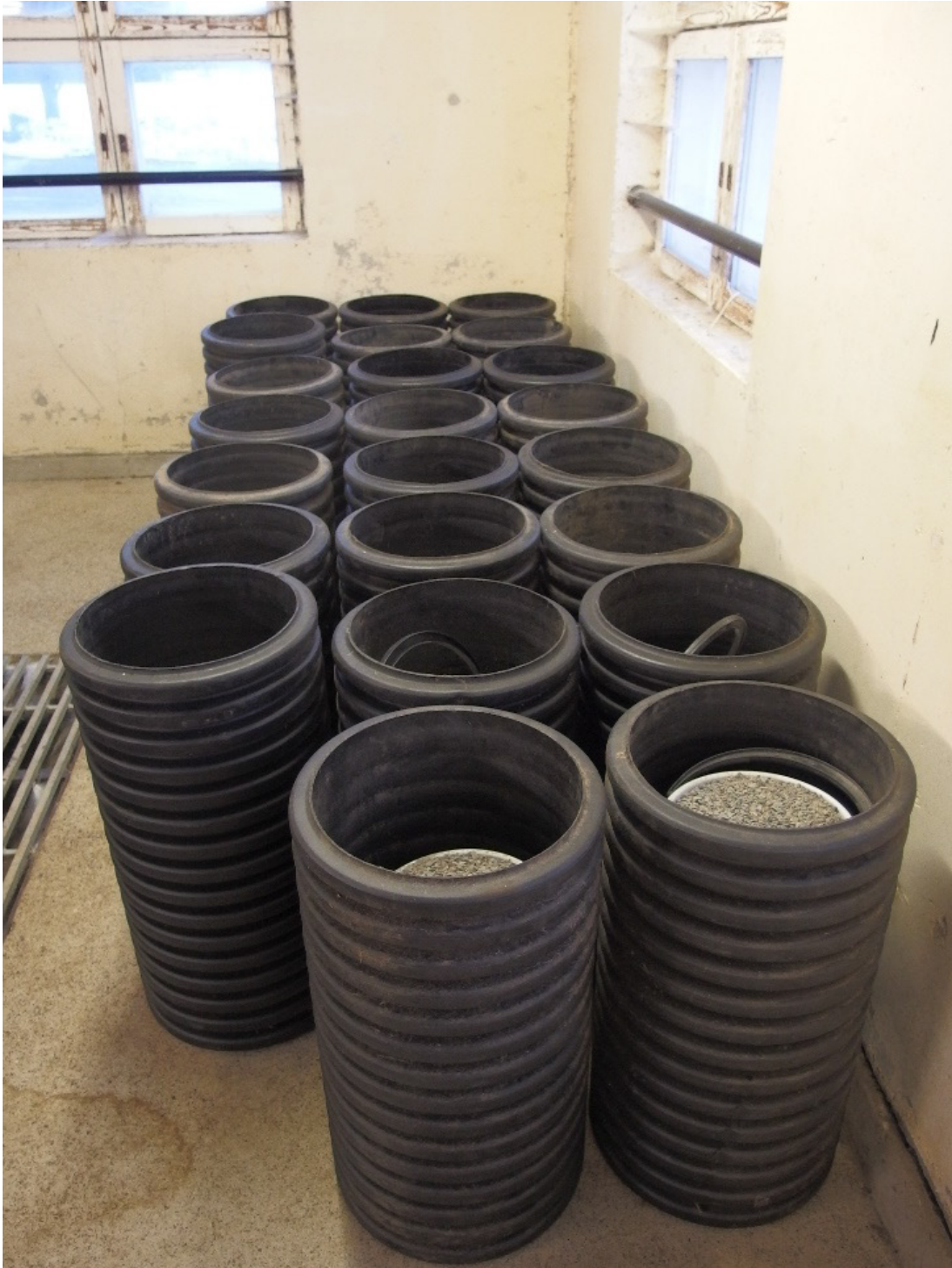
Kuva 28. Säilöntäkoheet minisiiloissa kivimurskalla painotettuna. Kuva: Anna-Liisa Välimaa, Luke.
