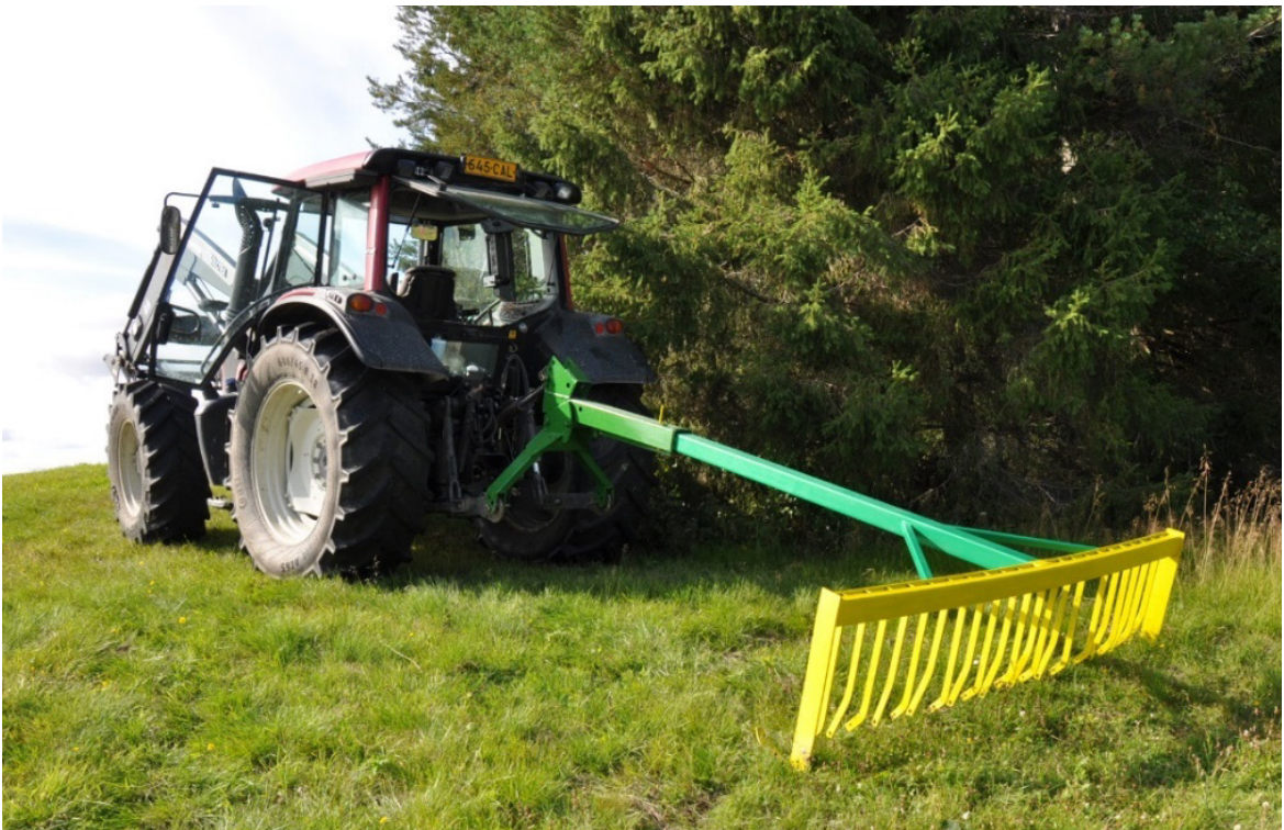
Kuva 14. Traktorin perään rakennettu haravalisäosa. Kuva: Ritva Nilivaara, SYKE.
