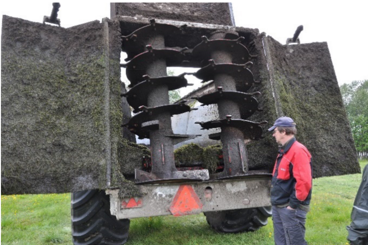
Kuva 18. Lannanlevittimen repijäruuvit ja levityslautaset. Kuva: Timo Lötjönen, Luke.
