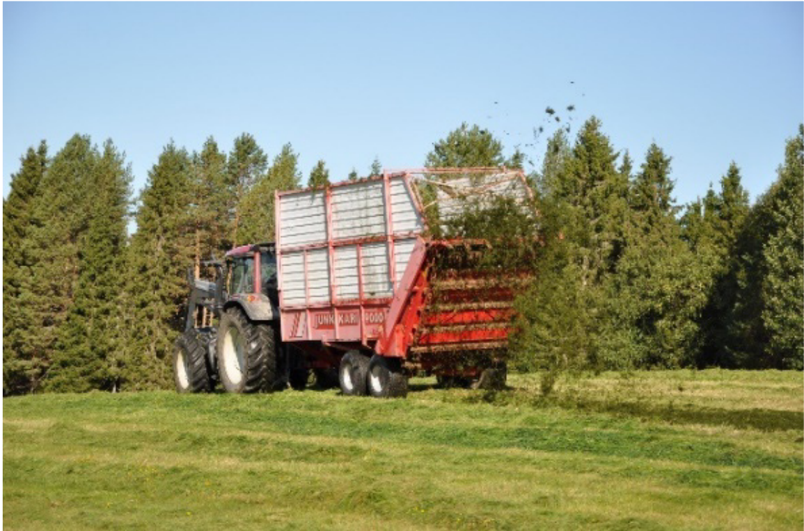
Kuva 21. Itsepurkava yleisperävaunu. Kuva Timo Lötjönen, Luke.
